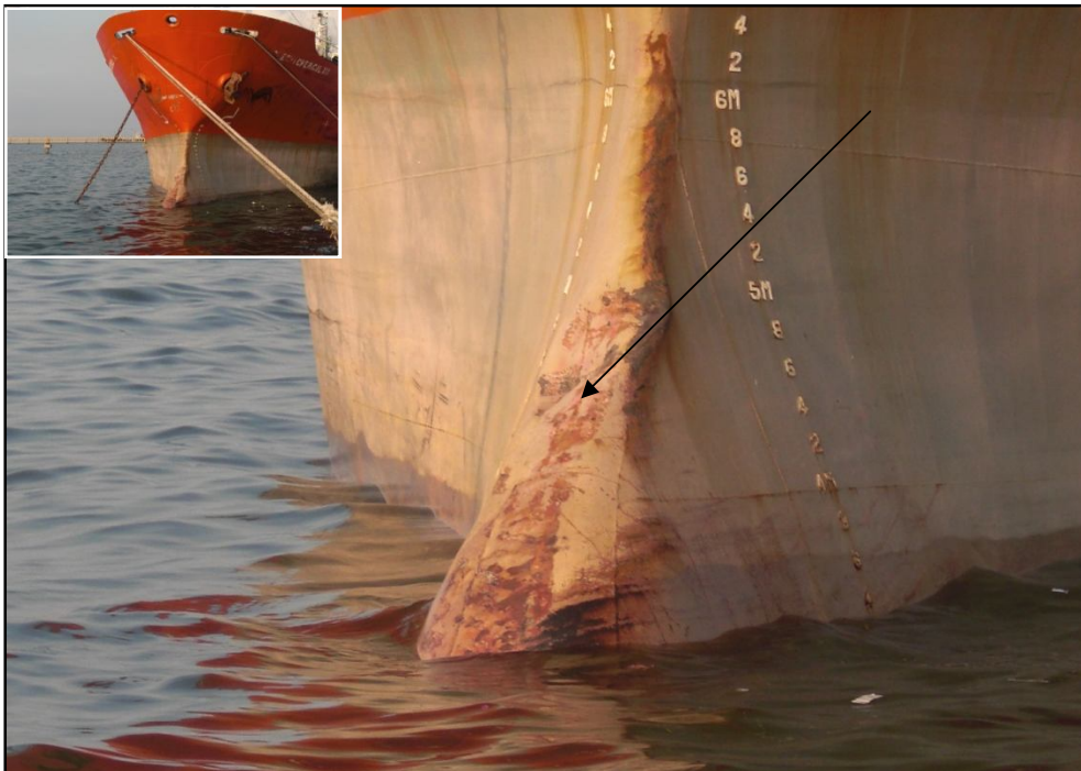
Gambar I-5 Kerusakan MT. Soechi Chemical XIX pada bagian haluan
