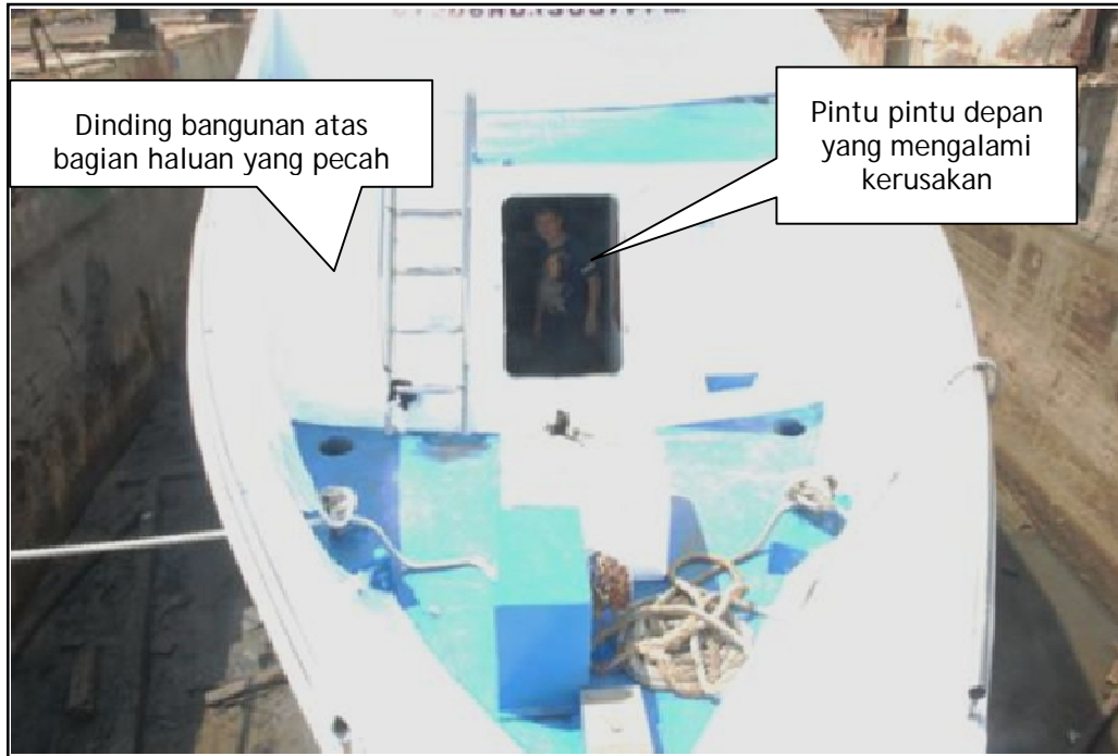
Gambar II-9 KM. Kondisi Bangunan Atas bagian Haluan KM. Express Bahari 8B
