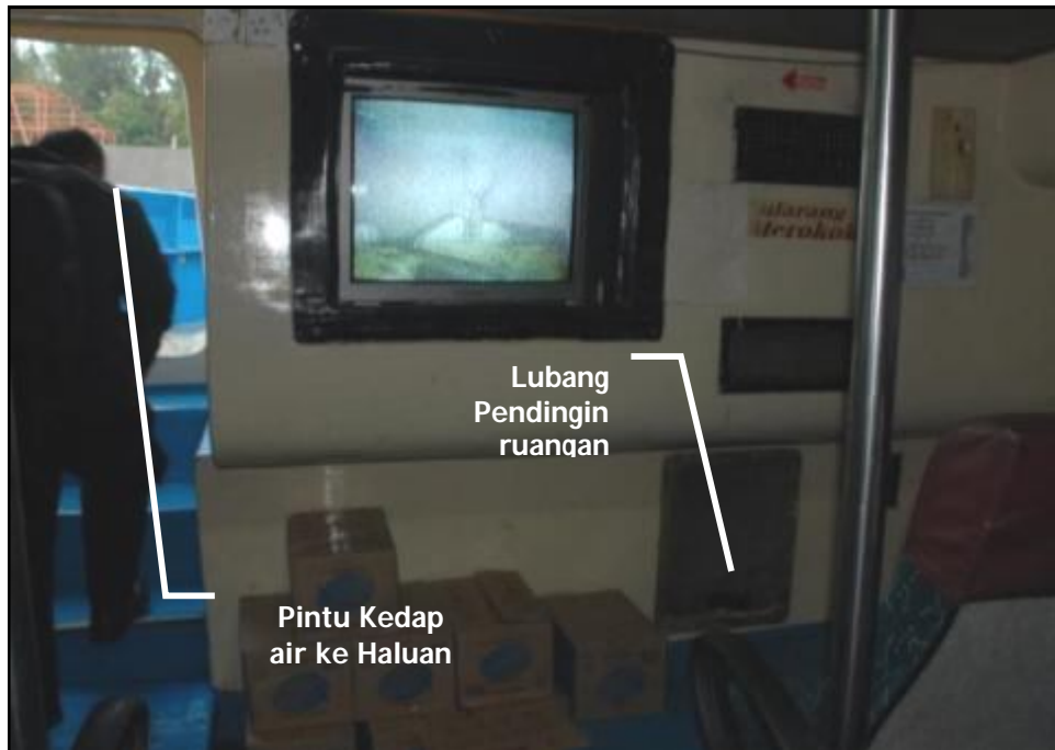
Gambar II-4 Lokasi masuknya air melalui lubang sirkulasi udara
