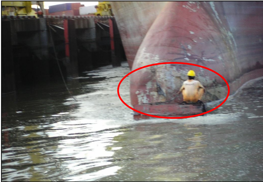
Kerusakan Akibat tubrukan di bagian Bulbous Bow KM. Mitra Ocean
