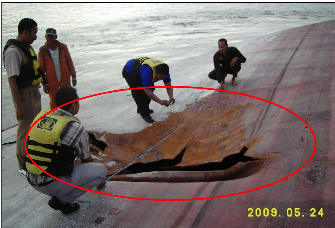
Kerusakan akibat tubrukan di bagian lambung kiri KM. Tanto Niaga.
