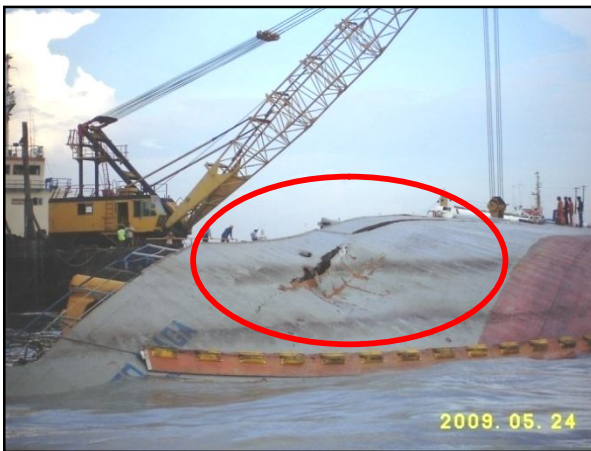
Kerusakan akibat tubrukan di bagian haluan kiri KM. Tanto Niaga.
