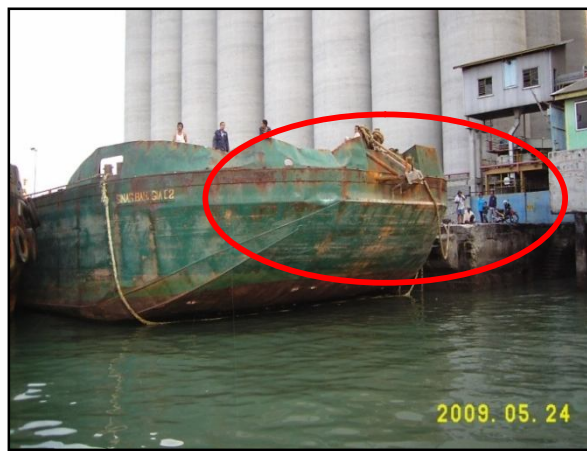
Kerusakan akibat tubrukan di bagian haluan Tongkang. Sinar Bahagia C2.
