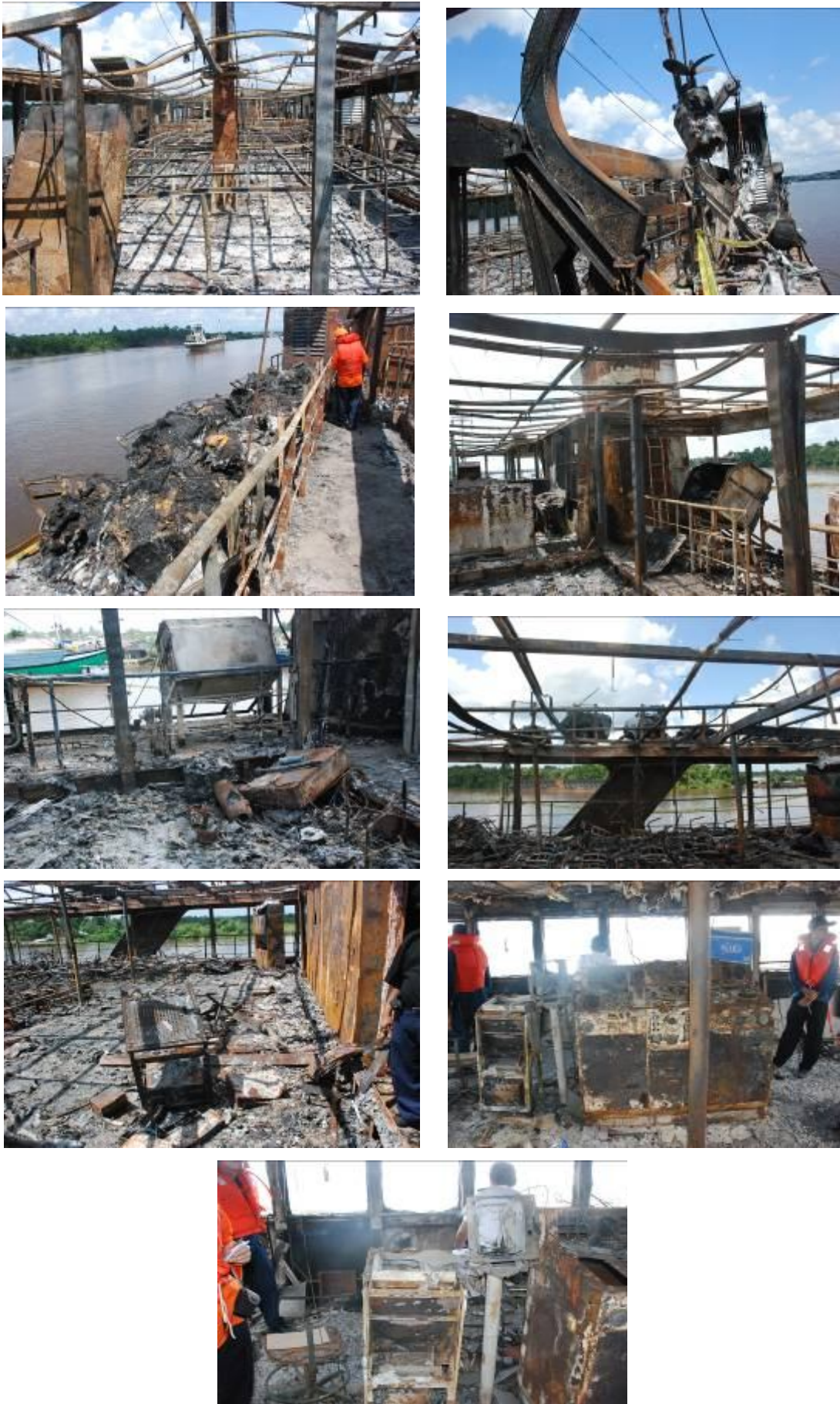
Gambar II-5 akibat kebakaran pada daerah akomodasi penumpang
