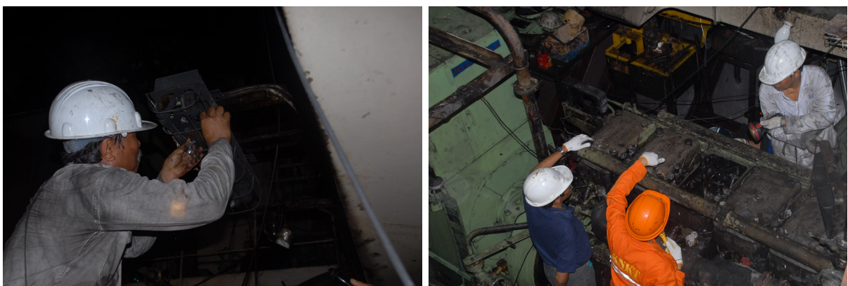
Gambar I-3 Pengambilan residu dan pemeriksaan kondisi AE no.2
