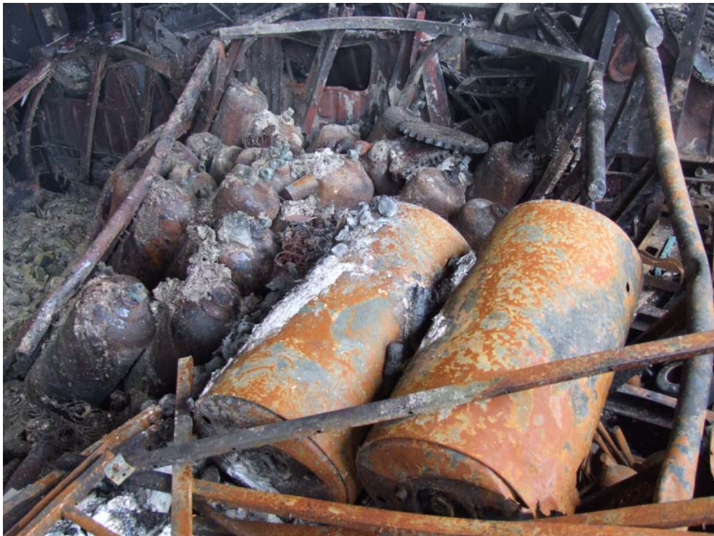
Gambar III-4 muatan tabung gas yang berada di atas truk di geladak kendaraan I yang diperkirakan sebagai lokasi awal kebakaran
