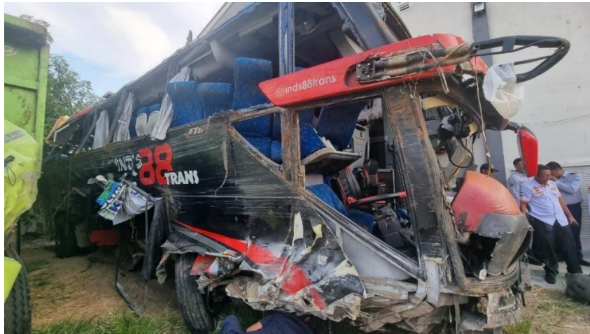
Gambar 7. Pilar (hollow 60x30x1,8mm) sisi kanan Tengah bus yang bengkok/patah menyebabkan atap kanan menimpa kursi penumpang
