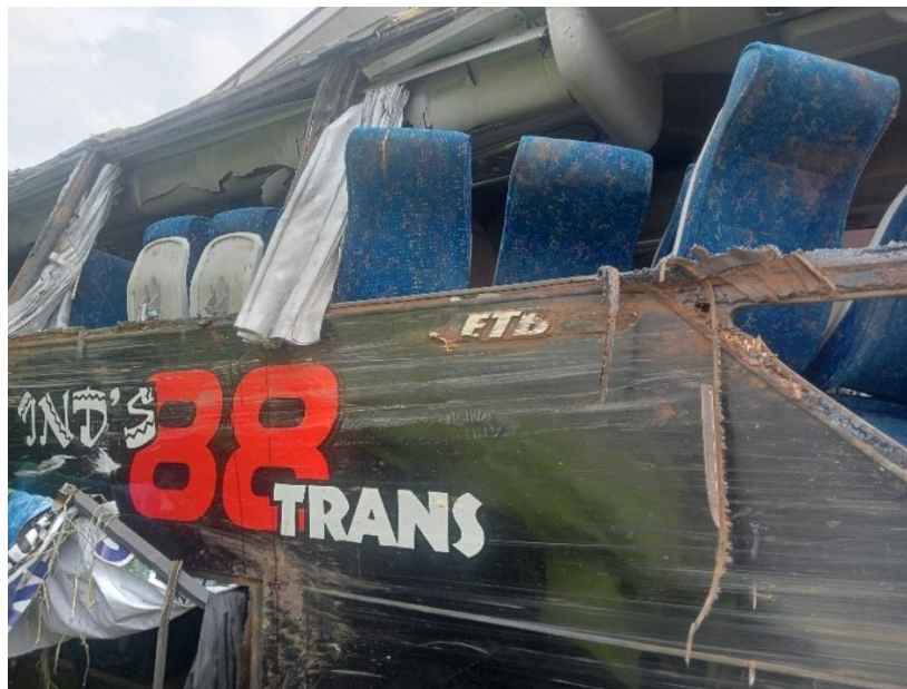
Gambar 7. Pilar (hollow 60x30x1,8mm) sisi kanan Tengah bus yang bengkok/patah menyebabkan atap kanan menimpa kursi penumpang
