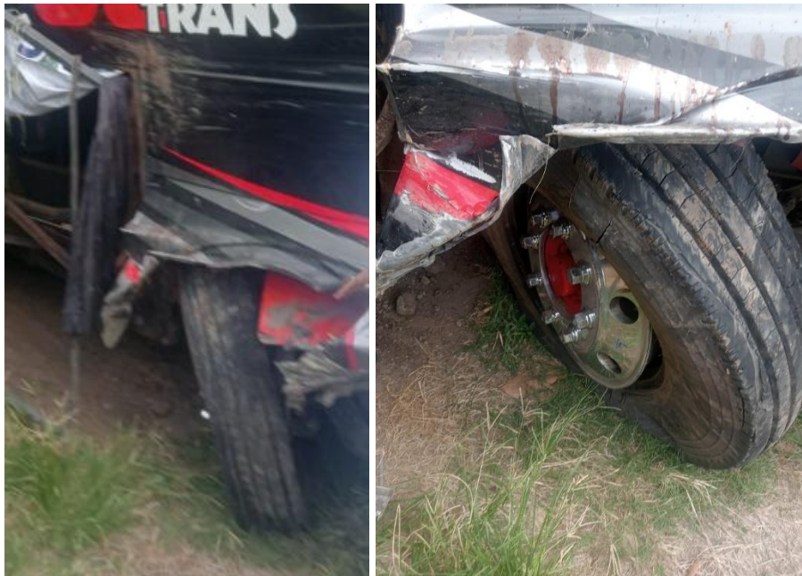
Gambar 11. Roda kanan depan mobil bus yang pecah
