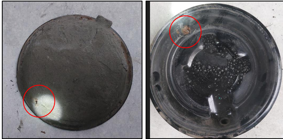
Gambar 24. Tutup chamber parking brake sumbu 3 kanan berlubang korosi
