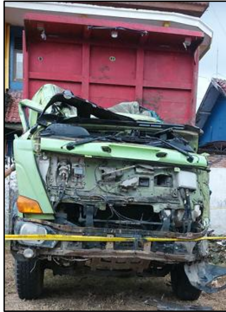
Gambar 4. Kondisi bagian depan dump truck kedua, atap kabin terdeformasi
