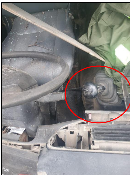
Gambar 28. Posisi akhir tuas gigi transmisi dump truck kedua
