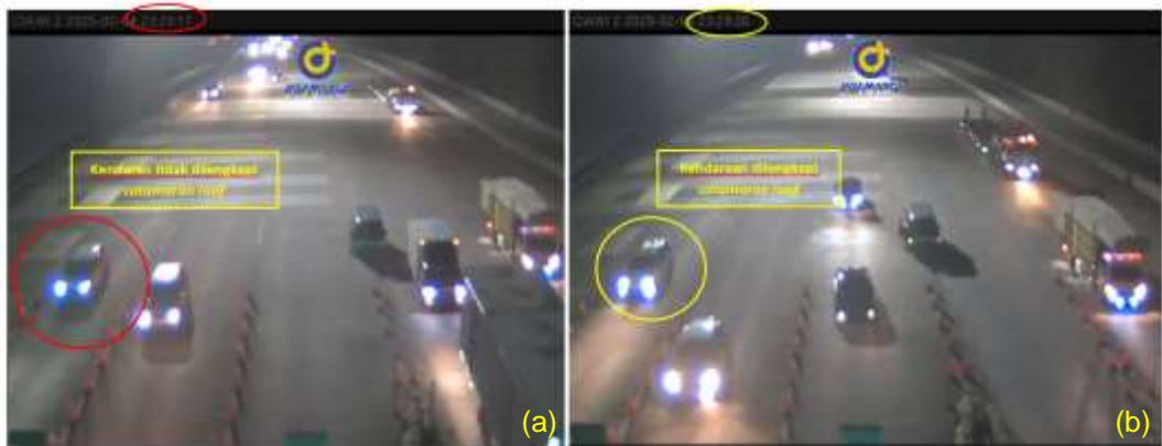
Gambar 33. Perbandingan hasil tangkapan CCTV terhadap dua kendaraan yang berada di gardu 5 GT Ciawi 2 (a) tidak terdapat pantulan catamaran roof pada bagian atap mobil, (b) terdapat pantulan catamaran roof pada bagian atap mobil.
