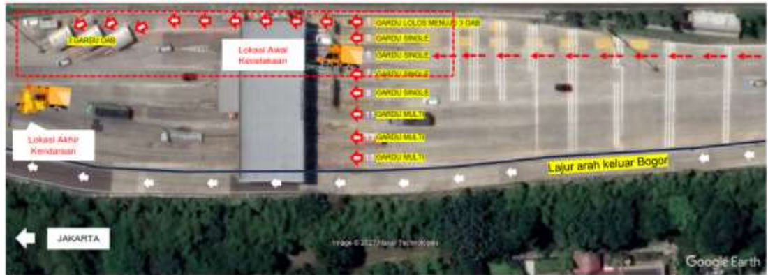
Gambar 17. Gerbang Tol Ciawi 2 memiliki 7 lajur gardu transaksi dengan geometrik lurus, 3 lajur gardu dengan geometrik miring. Sumber: PT Jasa Marga (Persero)
