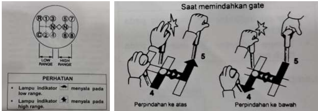
Gambar 6. Pola pemindahan transmisi truk flat deck [2]
