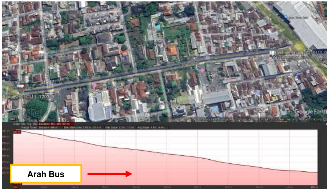
Gambar 24. Kondisi Alinyemen Jalan di Jalan Imam Bonjol
