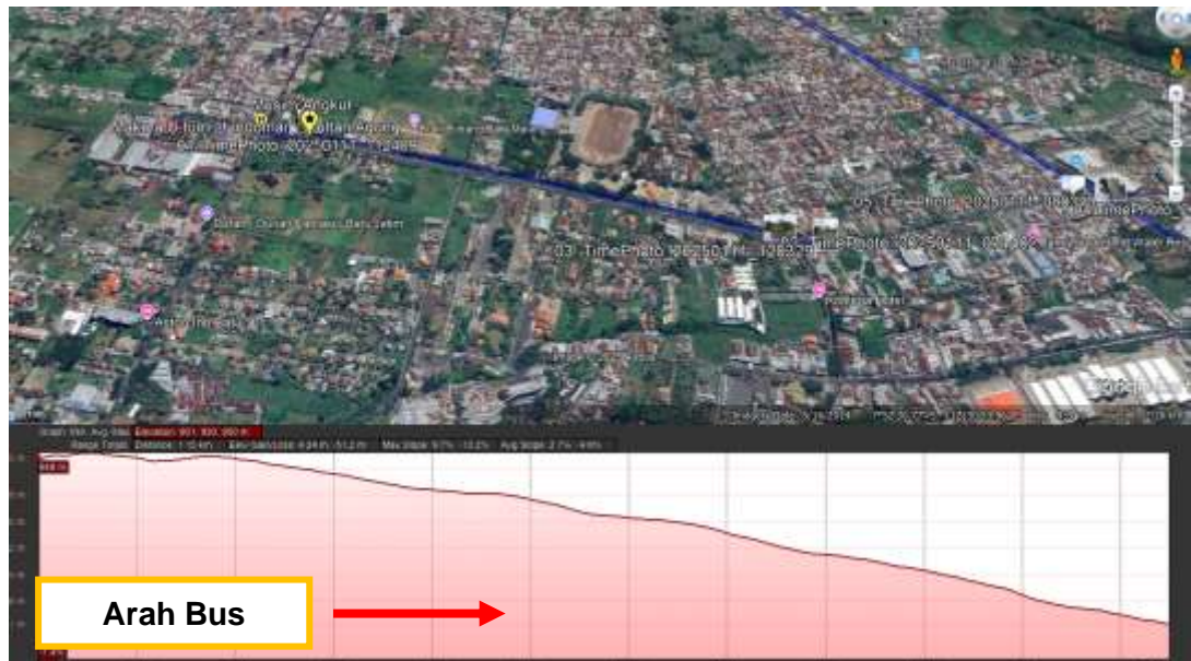
Gambar 41. Kelandaian Jalan Sultan Agung – Simpang 3 Jalan Imam Bonjol
