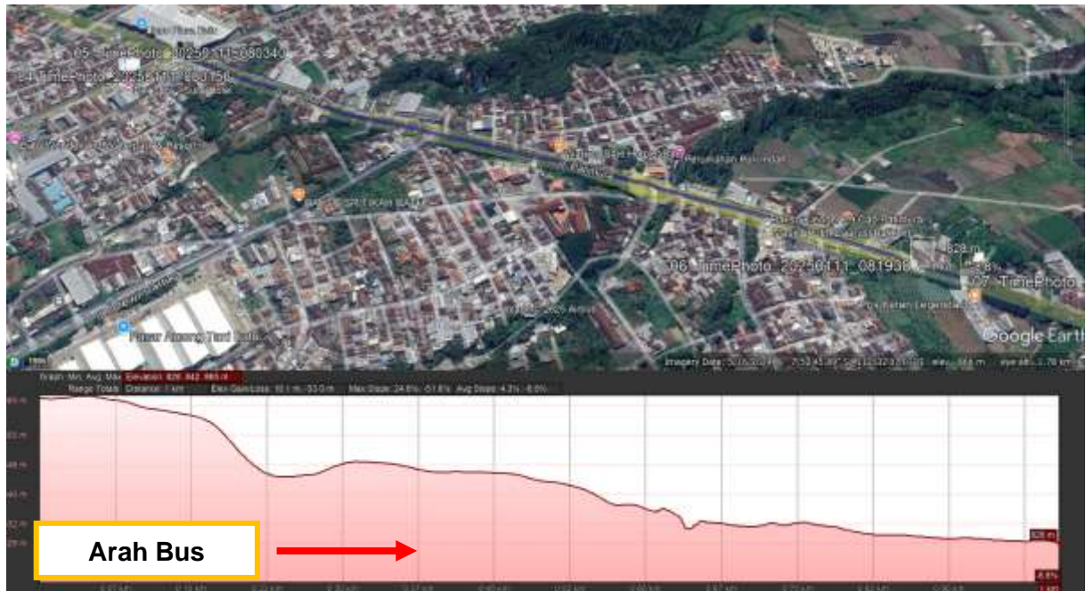
Gambar 26. Kondisi Alinyemen Jalan di Jalan Pattimura
