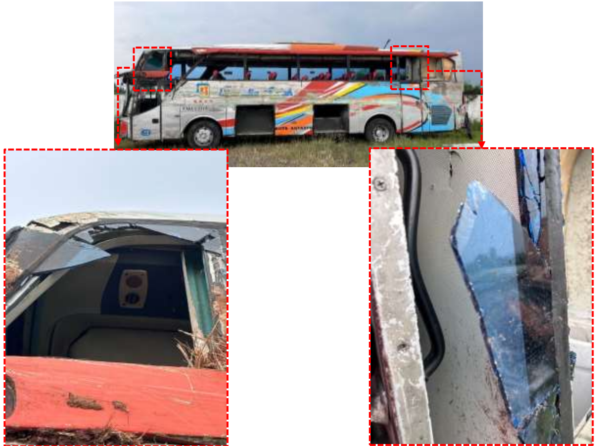
Gambar 6. Kaca jendela di atas pintu depan dan belakang sebelah kiri non-tempered glass
