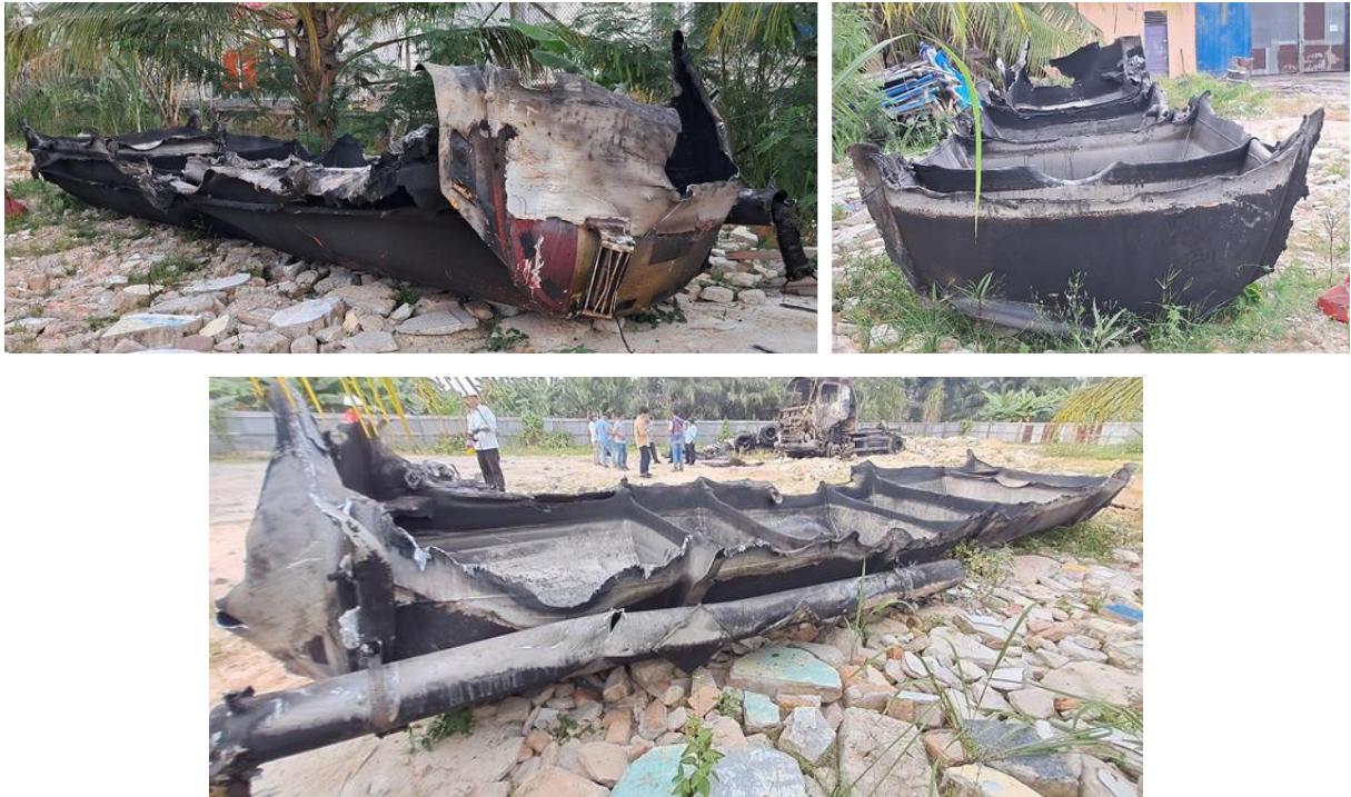
Gambar 4. Kondisi Tangki Setelah Terguling dan Terbakar
