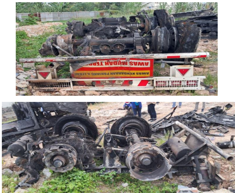
Gambar 3. Kondisi Kereta Tempelan Tangki Setelah Terguling dan Terbakar
