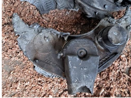
Gambar 37. Kondisi Beberapa Manhole Yang Mengalami Kerusakan Dampak Kebakaran Pada Truk Tangki Trailer
