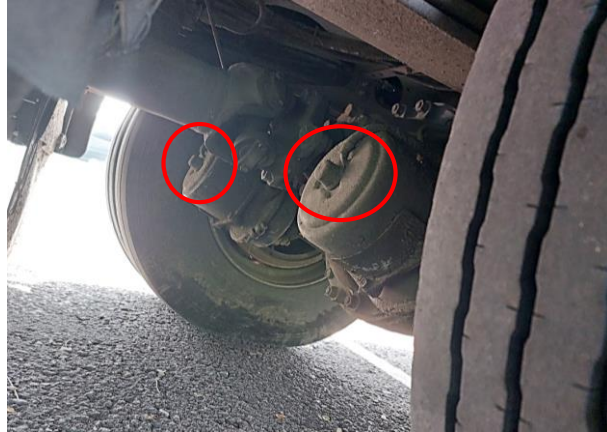
Gambar 18. Baut spring brake chamber tidak dilepas manual ( no caging )
