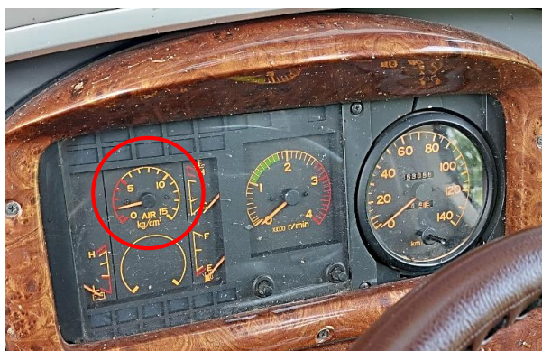
Gambar 16. Indikator Tekanan udara sekitar 2 bar
