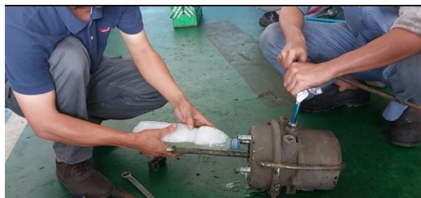
Gambar 23. Pemeriksaan kebocoran parking brake chamber
