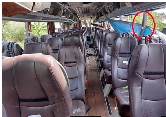
Gambar 6. Bagian dalam mobil bus, deformasi superstruktur pada tiang jendela
