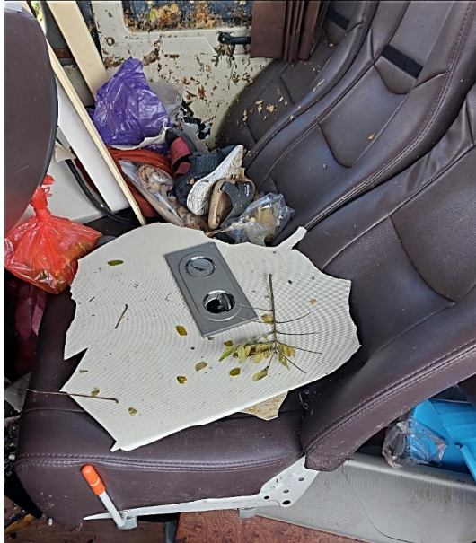
Gambar 8. Akses pintu darurat di dinding kanan terhalang kursi penumpang
