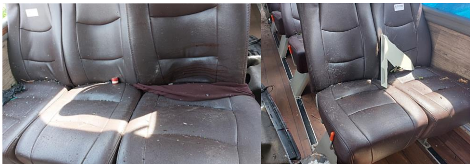
Gambar 7. Kursi penumpang tidak terpasang sabuk keselamatan
