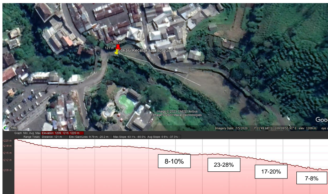
Gambar 12. Geometrik, penampang memanjang di lokasi kejadian kecelakaan. Kemiringan Jalan di tempat parkir tambahan 8-10% dan jalan turunan depan parkir mobil bus 23 – 28%.
