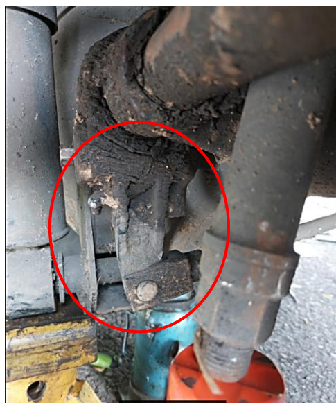
Gambar 20. Posisi slack adjuster 90°
