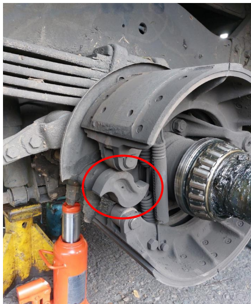
Gambar 19. Posisi S-cam mendorong sepatu rem
