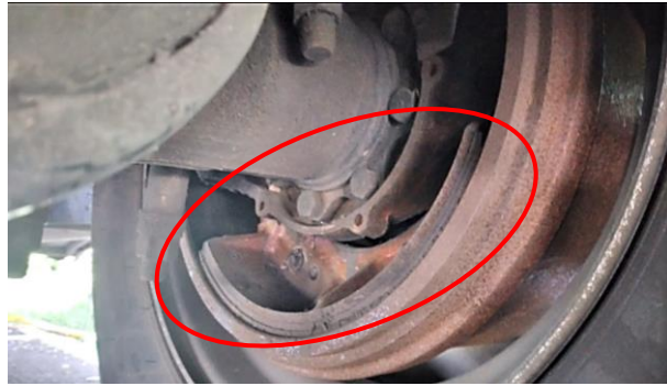
Gambar 21. Kampas rem menempel atau tidak ada celah ke tromol rem
