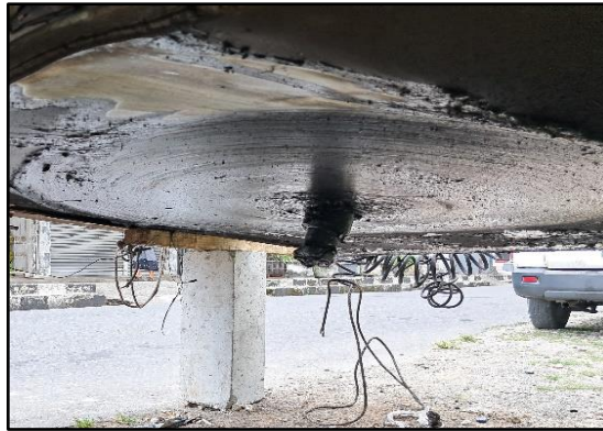
Gambar 7. Kondisi kingpin pada trailer yang telah mengalami deformasi
