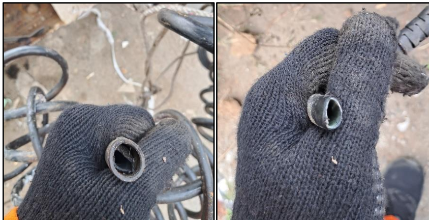
Gambar 8. Kondisi selang udara sistem pneumatic ke trailer yang putus akibat kecelakaan
