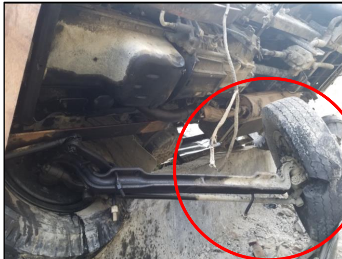
Gambar 5. Poros roda depan kiri terlepas akibat tabrak tebing
