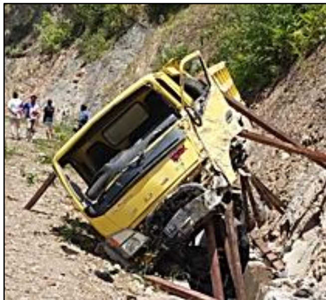
Gambar 3. Deformasi kabin dump truk akibat tabrak tebing
