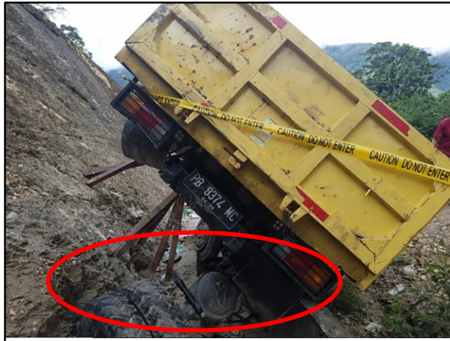
Gambar 4. Poros roda belakang kiri terlepas akibat tabrak tebing
