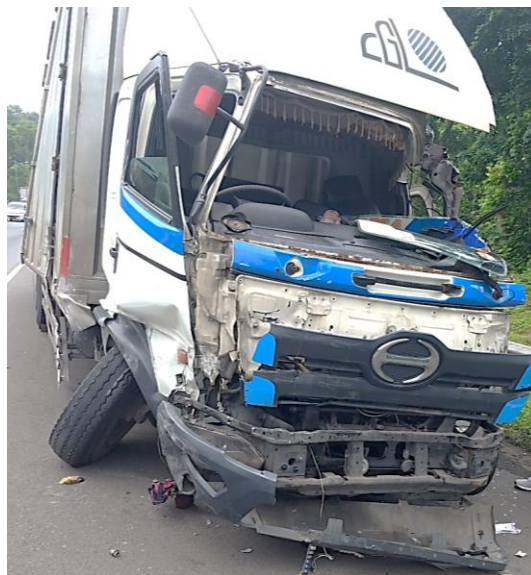
Gambar 3. Bodi samping tronton box , roda kanan depan patah
