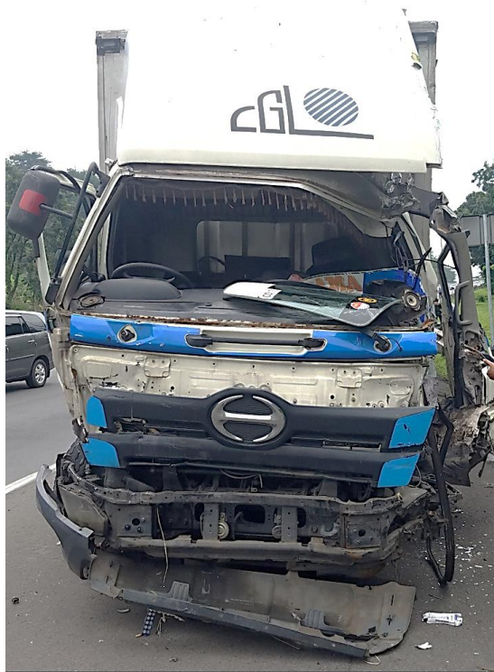
Gambar 2. Bodi depan tronton box terdeformasi
