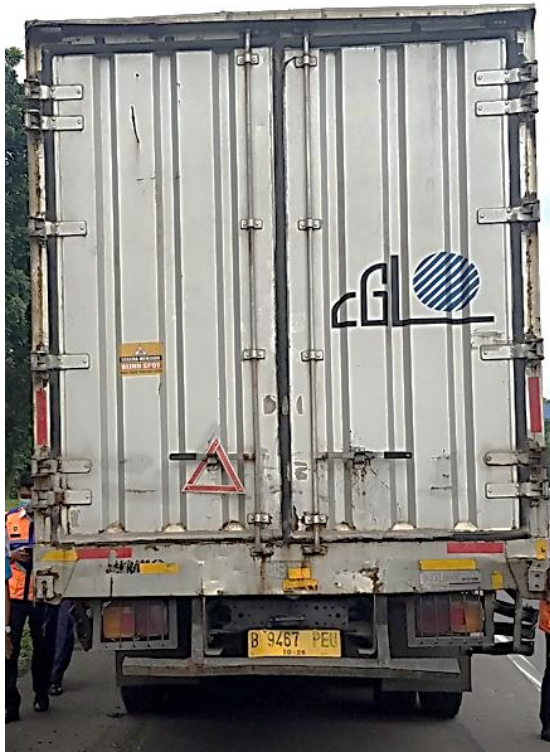
Gambar 4. Bagian belakang tronton box tidak terdeformasi
