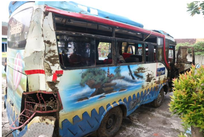
Gambar 6. Kondisi Tampak Samping Kanan Kendaraan Yang Telah Terdeformasi dan Kaca Jendela Mengalami Pecah
