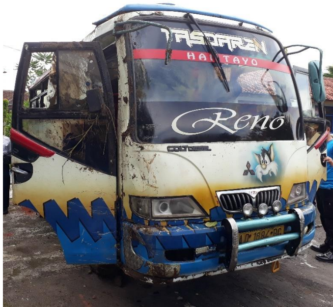
Gambar 5. Kondisi Tampak Depan Mobil Bus Tidak Terdeformasi
