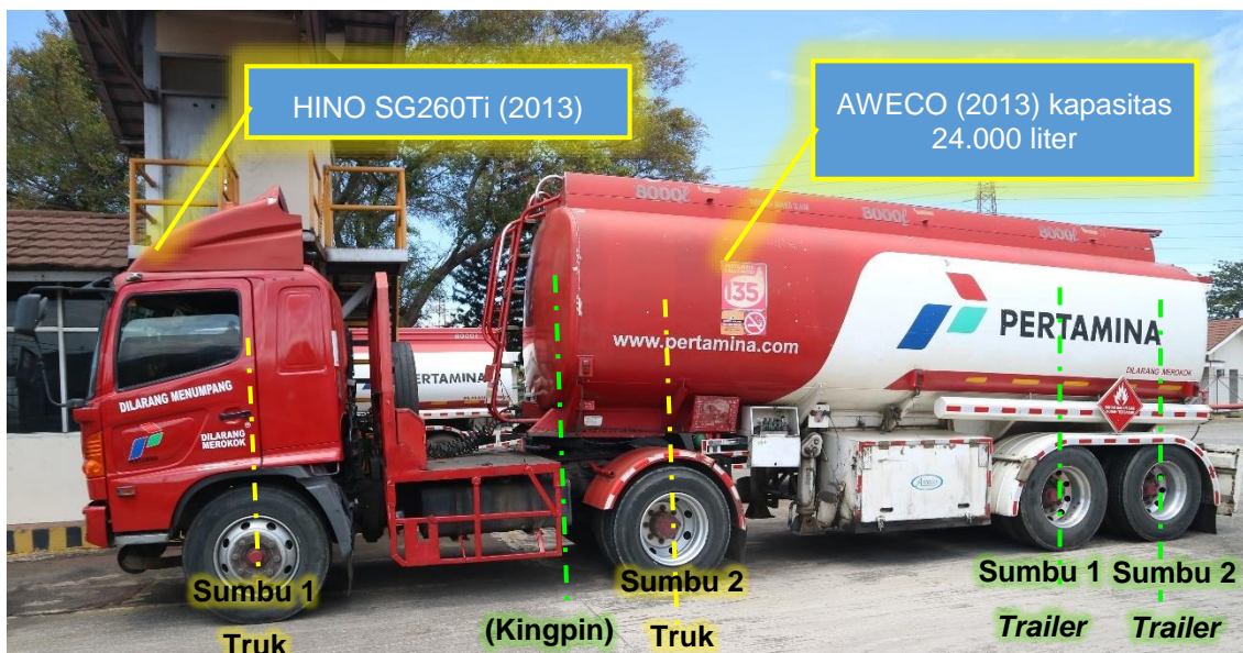
Gambar 2. Truk trailer tangki yang identik dengan truk trailer tangki B-9407-SEH
