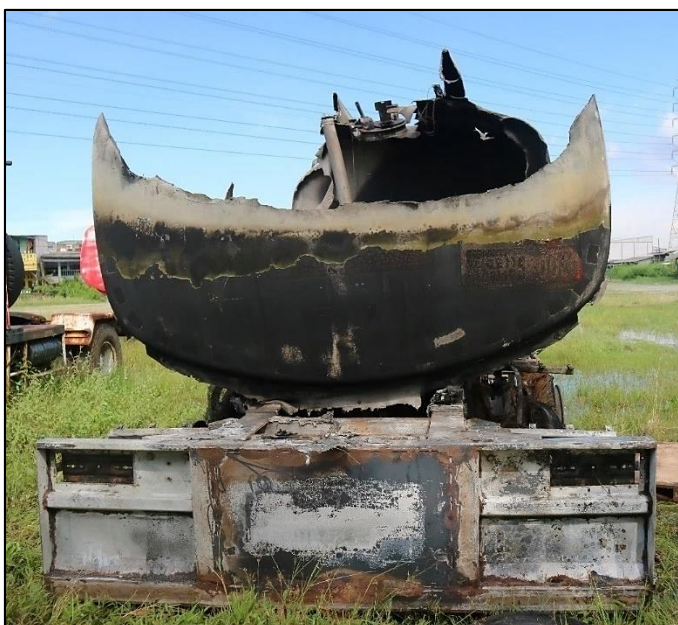
Gambar 6. Bagian belakang trailer tangki terbakar pada bumper dan tangki
