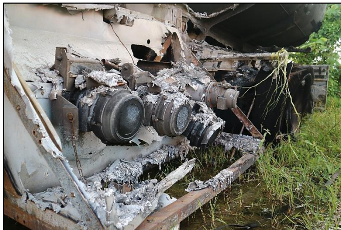
Gambar 9. Bottom loading box trailer tangki terbakar
