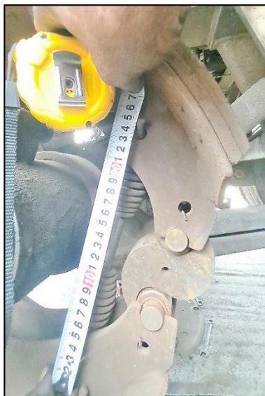
Gambar 18. Panjang pegas pembalik terpasang sepatu rem trailer identik \pm 250 mm
