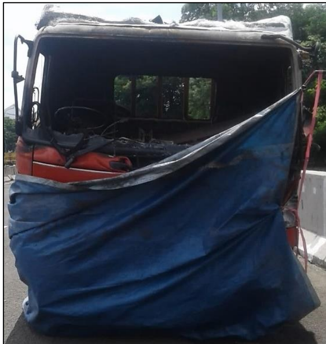
Gambar 10. Kabin truk penarik terbakar
