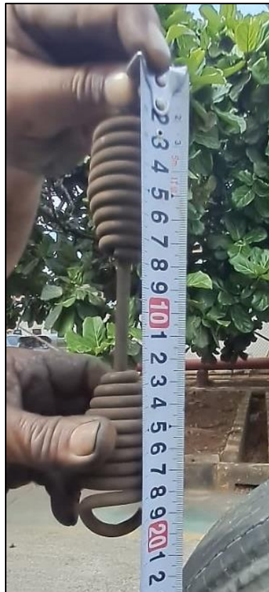
Gambar 17. Panjang komponen pegas pembalik sepatu rem identik \pm 200 mm
