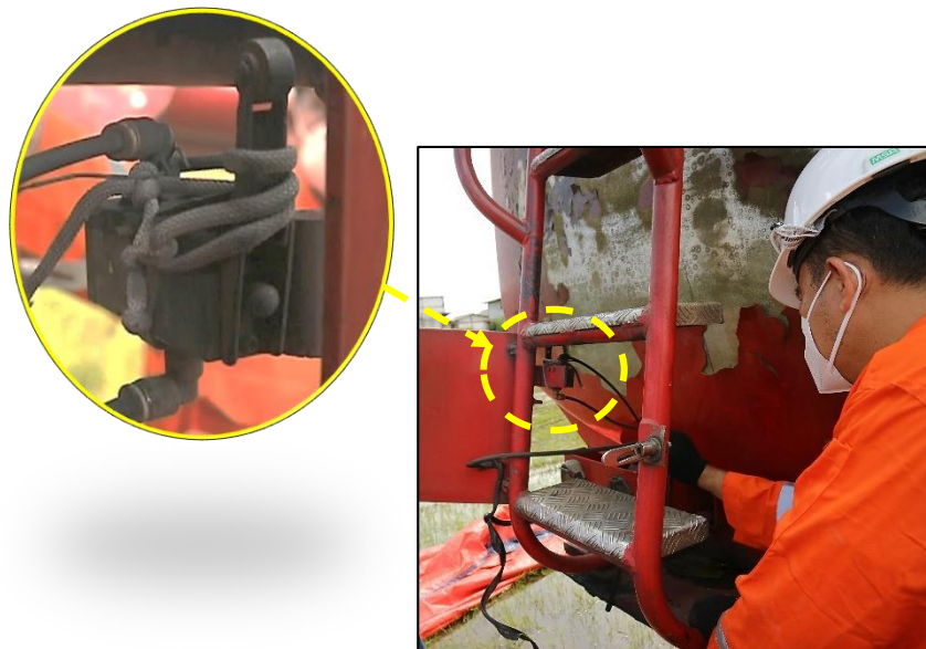
Gambar 21. Pneumatic limit switch pada tangga akses naik tangki yang telah dimodifikasi
