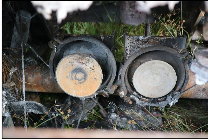
Gambar 8. Spring brake chamber terpasang di sumbu ke-2 trailer terbakar
