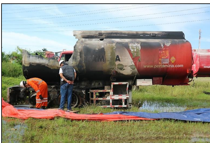
Gambar 7. Bagian kanan trailer tangki terbakar pada sasis dan sebagian tangki
