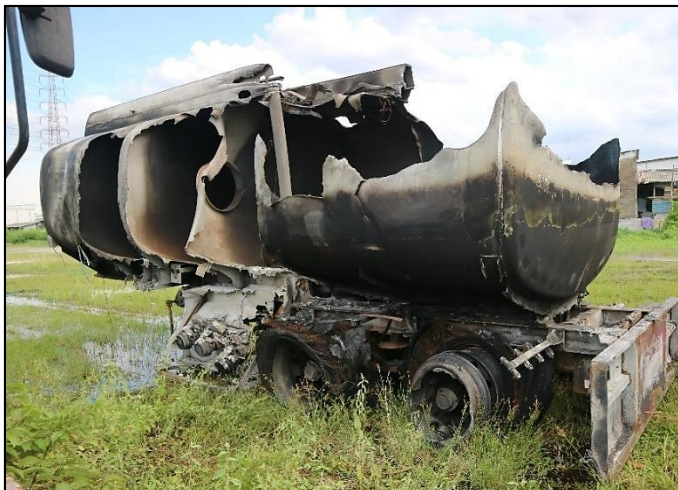
Gambar 5. Bagian kiri trailer tangki terbakar pada sasis dan tangki
