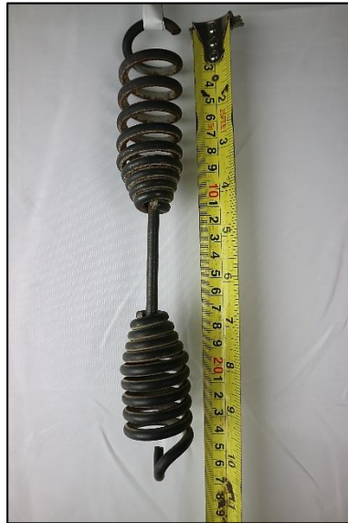
Gambar 16. Panjang pegas pembalik sepatu rem trailer terbakar \pm 265 mm
