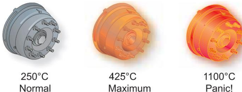
Gambar 33. Kampas rem beroperasi di suhu 250°C dan tidak boleh melebihi 425°C[4]
