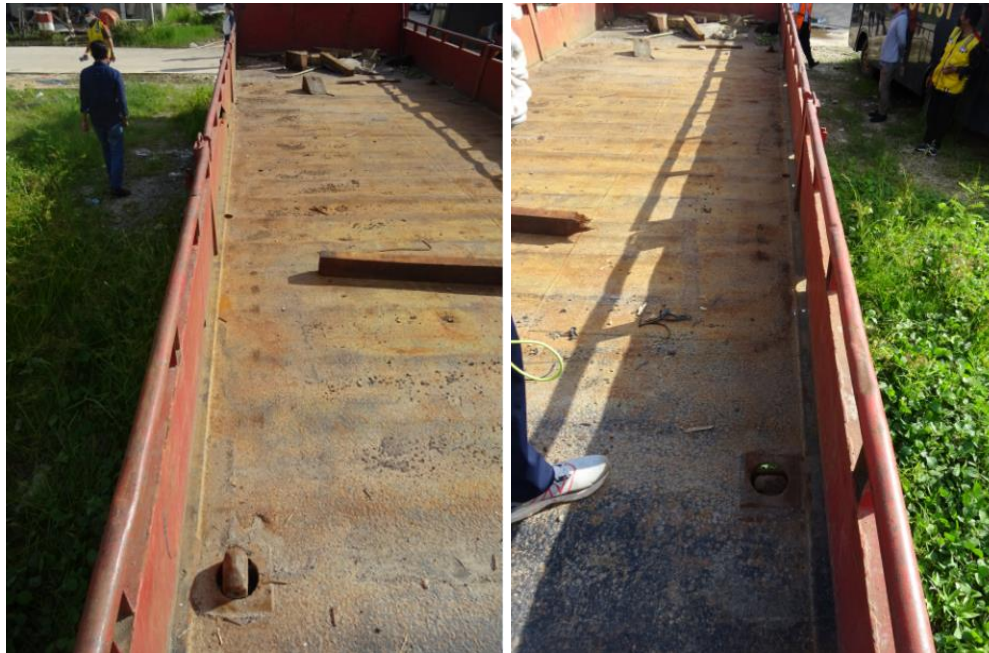
Gambar 21 Kondisi bak terbuka terdapat empat twist lock untuk kontainer
