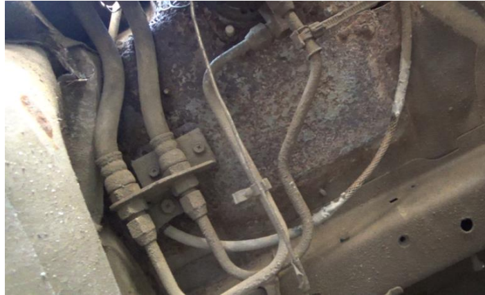
Gambar 19 Pemeriksaan slang flexible, slang logam, dan konektor
