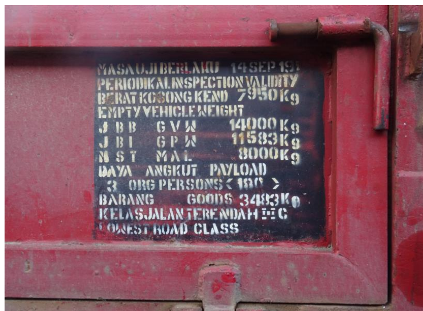
Gambar 22 Daya angkut barang yang tertera di bak truk
