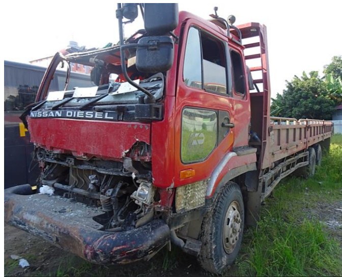
Gambar 11 Deformasi kecil pada bumper besi, grille dan atap truk
