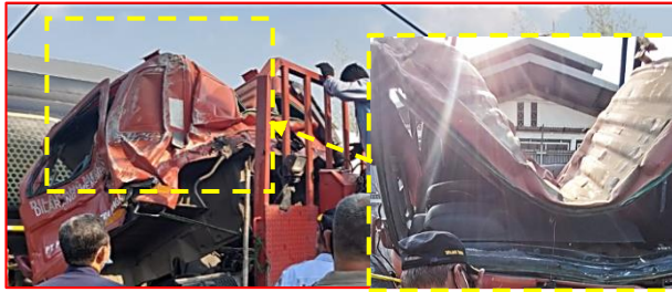
Gambar 3. Atap truk trailer tangki terdeformasi ke dalam kabin
