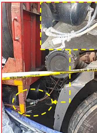
Gambar 10. Instalasi klakson tambahan sumber ke airtank
