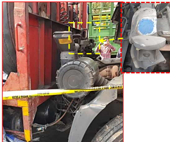
Gambar 8. Cab mounting cushion dimodifikasi pakai karet sandal
