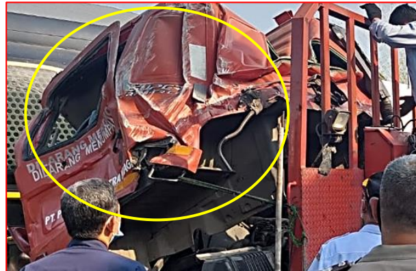
Gambar 4. Bodi kiri truk trailer tangki terdeformasi ke dalam kabin
