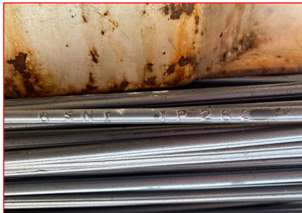
Gambar 26. Muatan besi beton uk. 8 mm sebanyak 14.208 batang
