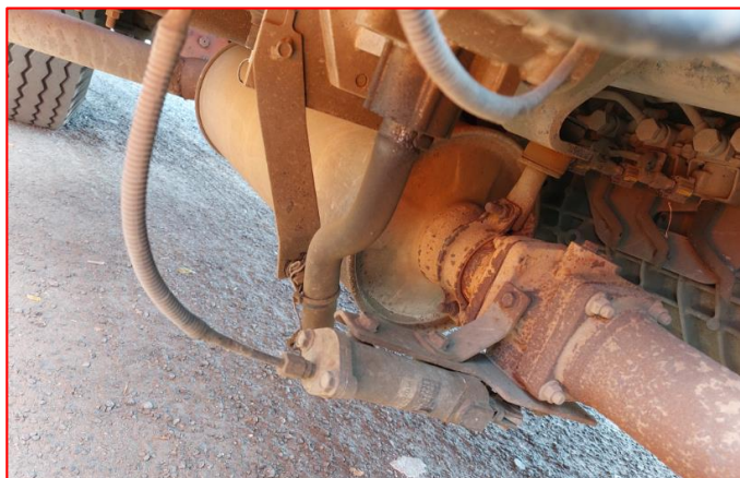
Gambar 18. Solenoid exhaust brake terpasang dan kondisi baik
