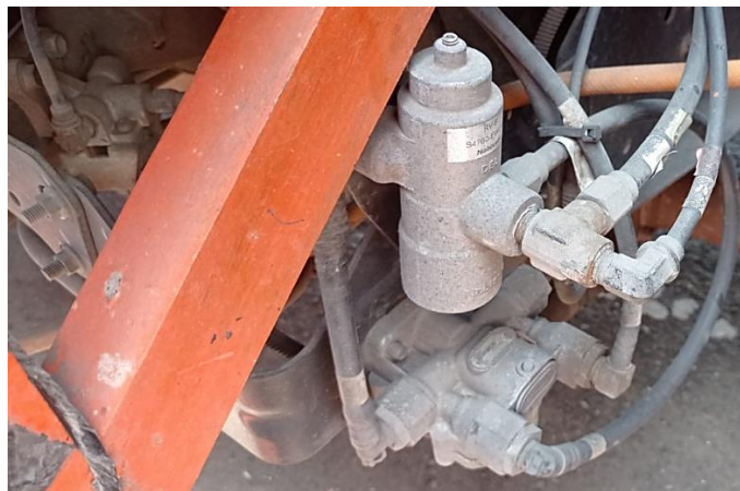
Gambar 17. Governor udara tekan dan selang rem kondisi baik
