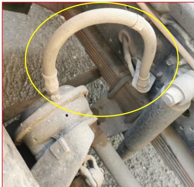
Gambar 15. Flexible hose ke single brake chamber dalam kondisi baik
