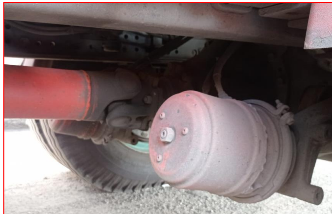
Gambar 14. Double brake chamber truk trailer dalam kondisi baik
