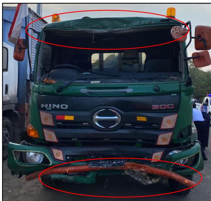
Gambar 4. Kondisi bagian depan truk penarik, terjadi deformasi pada bumper dan atap
