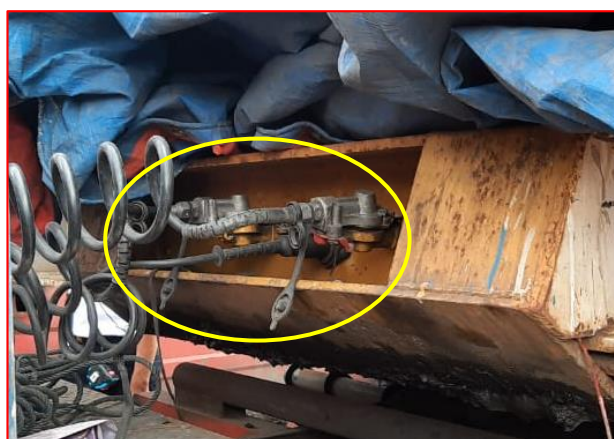
Gambar 21. Selang udara tekan truk penarik terhubung baik ke trailer
