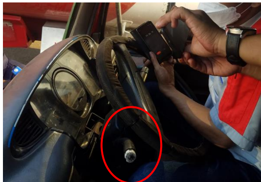
Gambar 3. Exhaust brake tidak berfungsi
