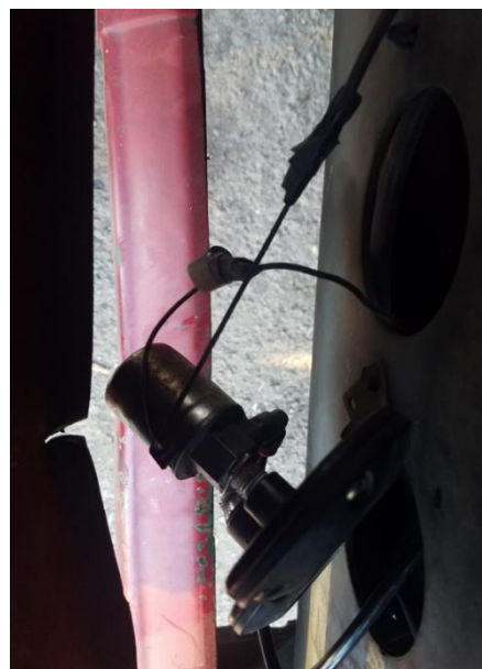
Gambar 4. Instalasi klakson tambahan terhubung ke tabung udara
