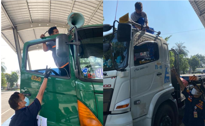
Gambar 24. Tindakan keselamatan melepas klakson tambahan saat uji berkala
