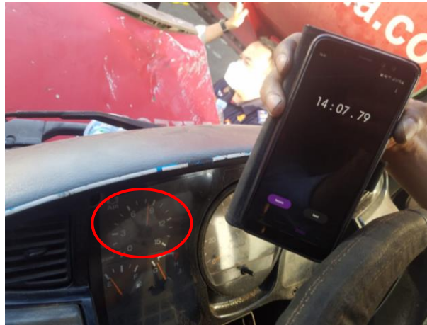
Gambar 17. Kinerja kompresor udara rem 9,5 bar selama 14.07 menit
