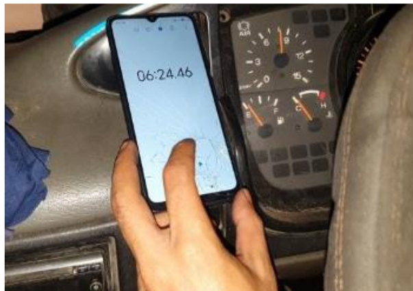
Gambar 18. Kinerja kompresor udara rem 8 bar selama 6.24 menit
