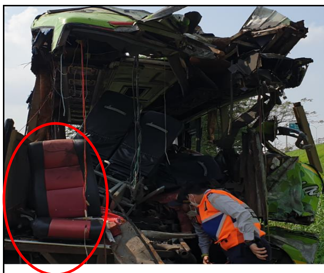
Gambar 6. Kursi penumpang bus wisata tidak dilengkapi dengan sabuk keselamatan
