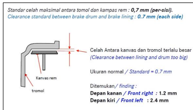
Gambar 28. Jarak antara kampas rem dengan tromol roda depan
