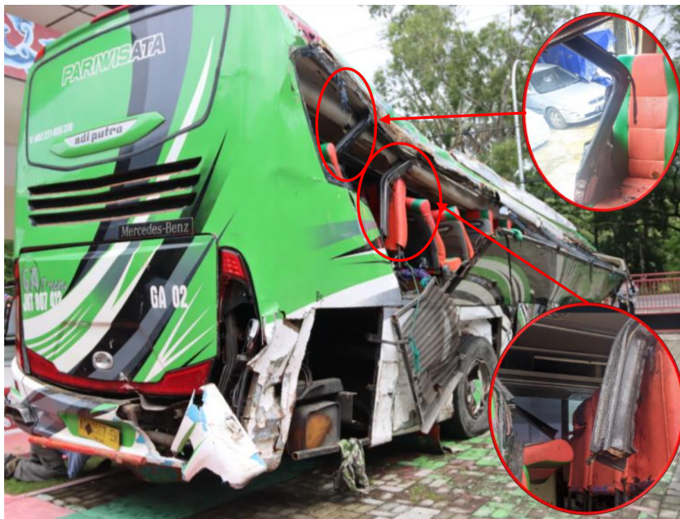
Gambar 4. Pilar pintu darurat bus wisata patah
