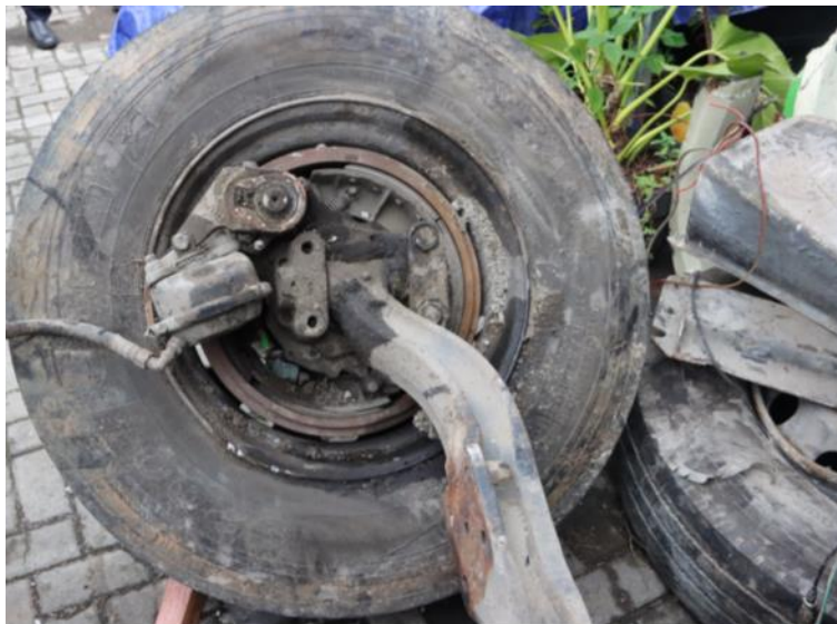
Gambar 9. Kondisi roda depan tromol tidak tertutup
