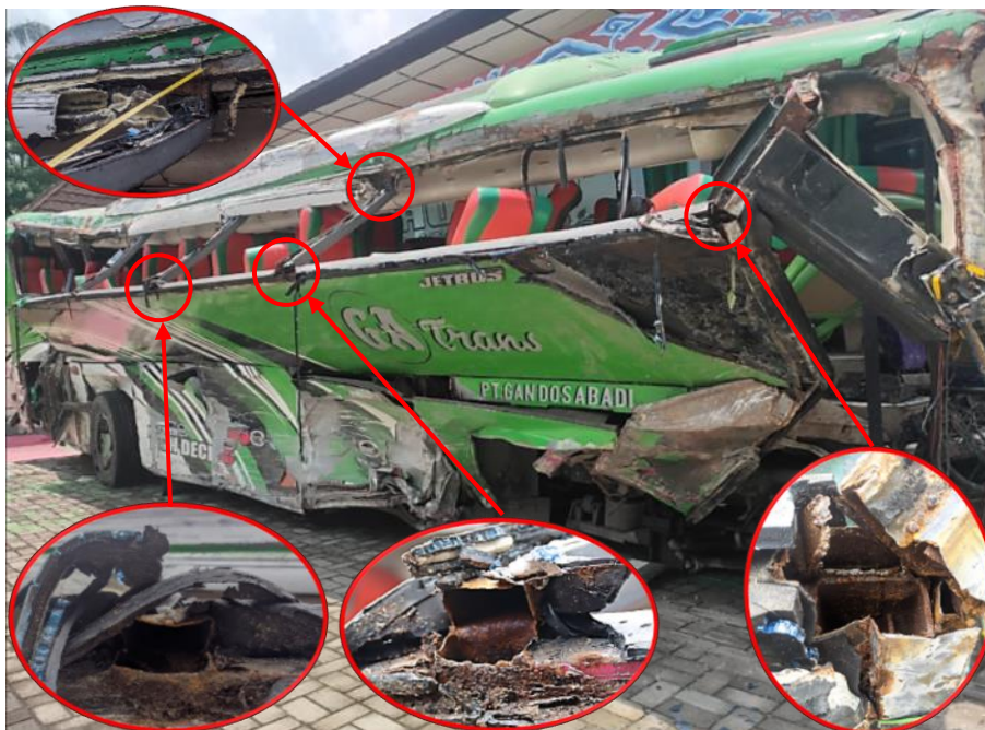
Gambar 3. Semua pilar ( hollow 60x30x1,8mm ) patah di bodi kanan bus wisata
