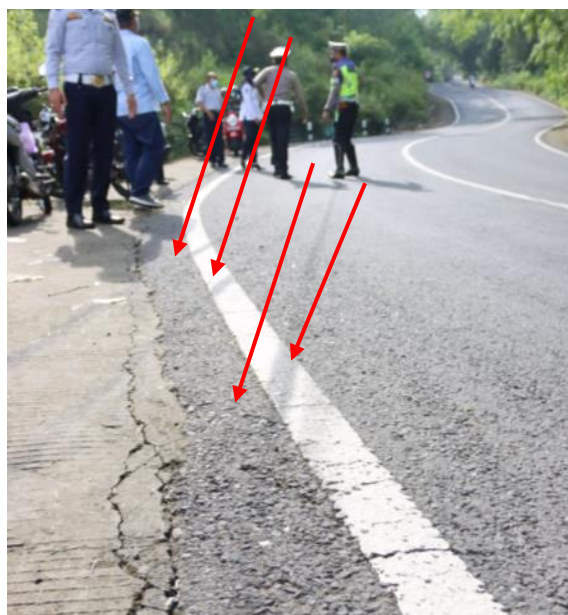
Gambar 24. Skid Marks ban bus wisata lurus menuju bahu jalan
