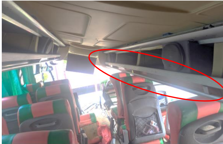
Gambar 6. Atap plafon kanan bus wisata runtuh menimpa sandaran kursi
