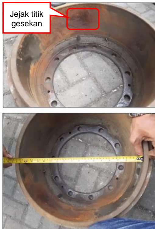
Gambar 29. Diameter dalam tromol 416 mm, standar keausan 414,02 mm
