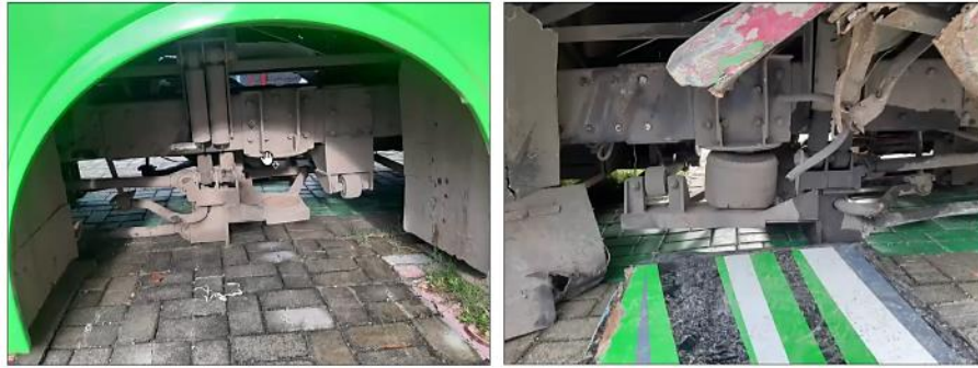
Gambar 27. Sistem air suspension bus wisata
