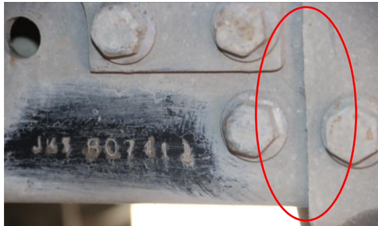
Gambar 13. Rangka bus wisata terdapat sambungan
