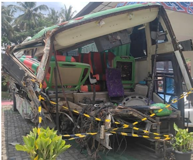
Gambar 2. Bodi depan bus wisata remuk dan roda depan terlepas
