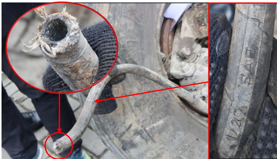
Gambar 10. Selang fleksibel rem putus akibat tabrakan, kondisi retak ( aging )
