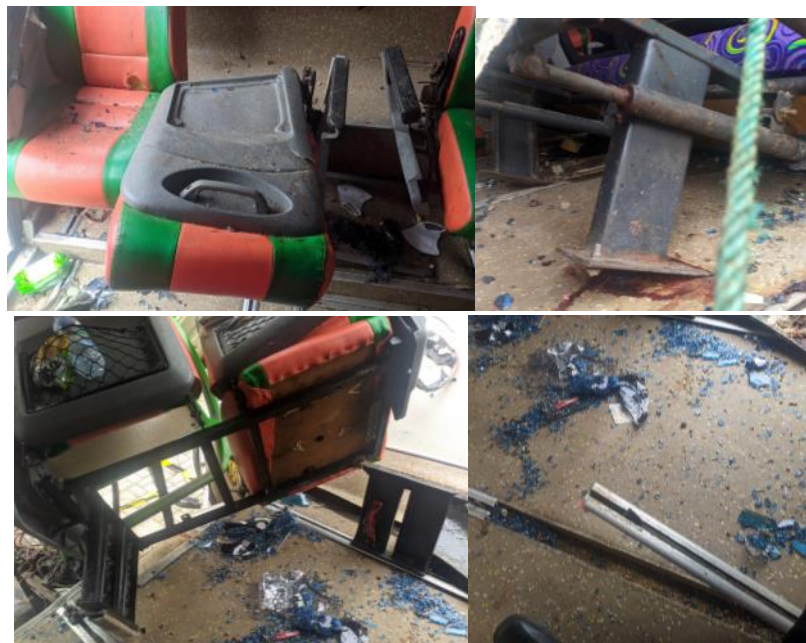
Gambar 14. Kursi penumpang tidak ada sabuk keselamatan, patah pada rangka, dudukan terlepas dari lantai dan rel patah.
