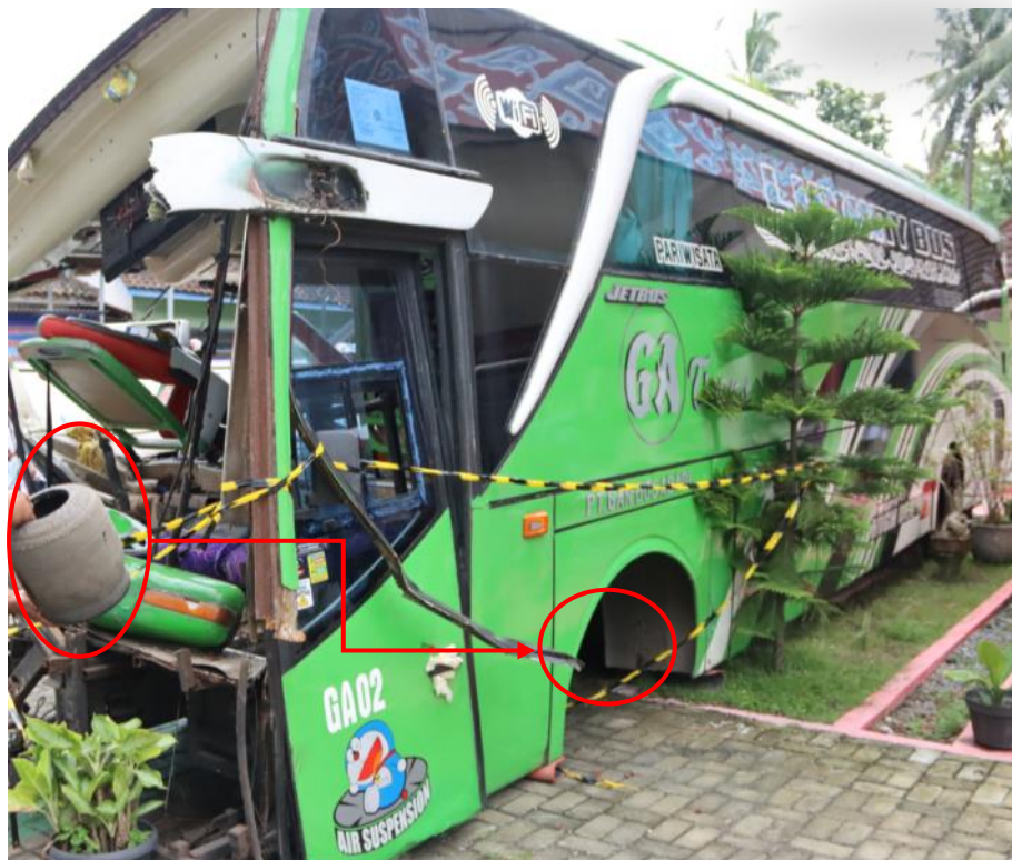
Gambar 5. Bodi bus wisata kiri tidak terdeformasi
