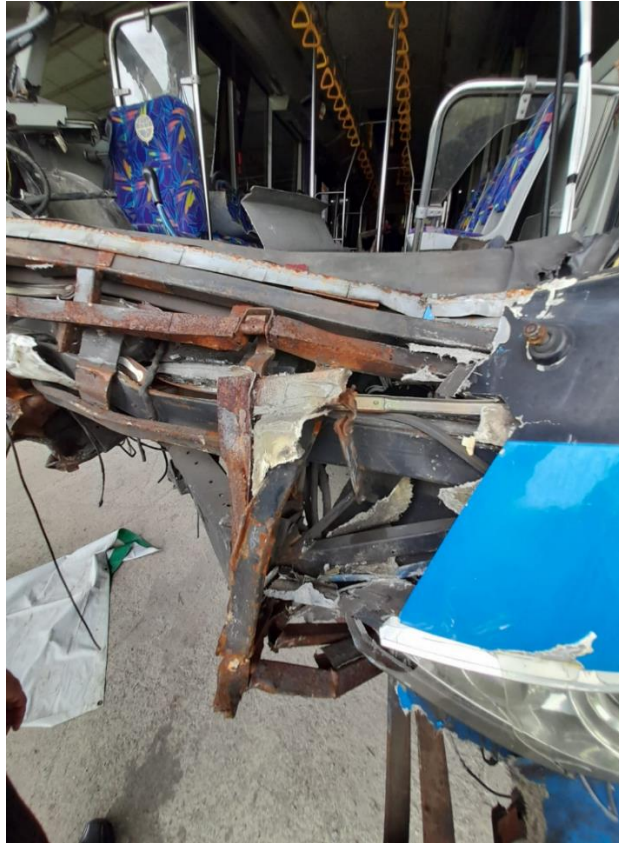
Gambar 4. Bodi Bus 1 Depan Setelah Kecelakaan
