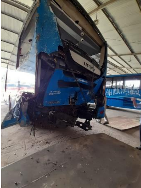
Gambar 10: Bodi Bus 2 Bagian Belakang Terdeformasi
