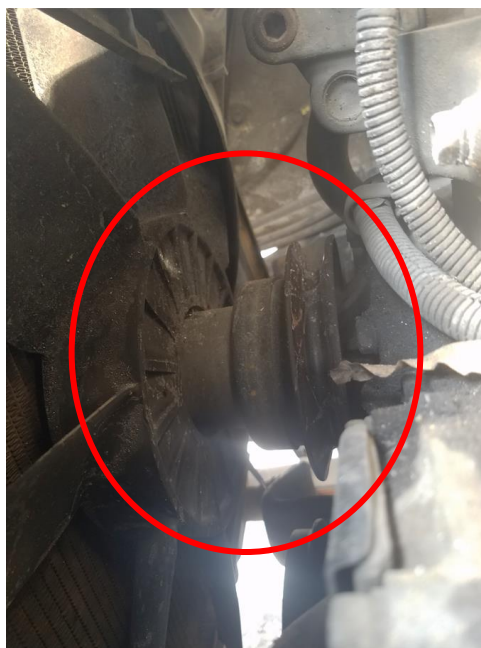
Gambar 3. Tidak ada tali kipas ( belt )
