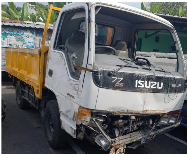
Gambar 2. Deformasi kabin truk akibat tabrak tembok
