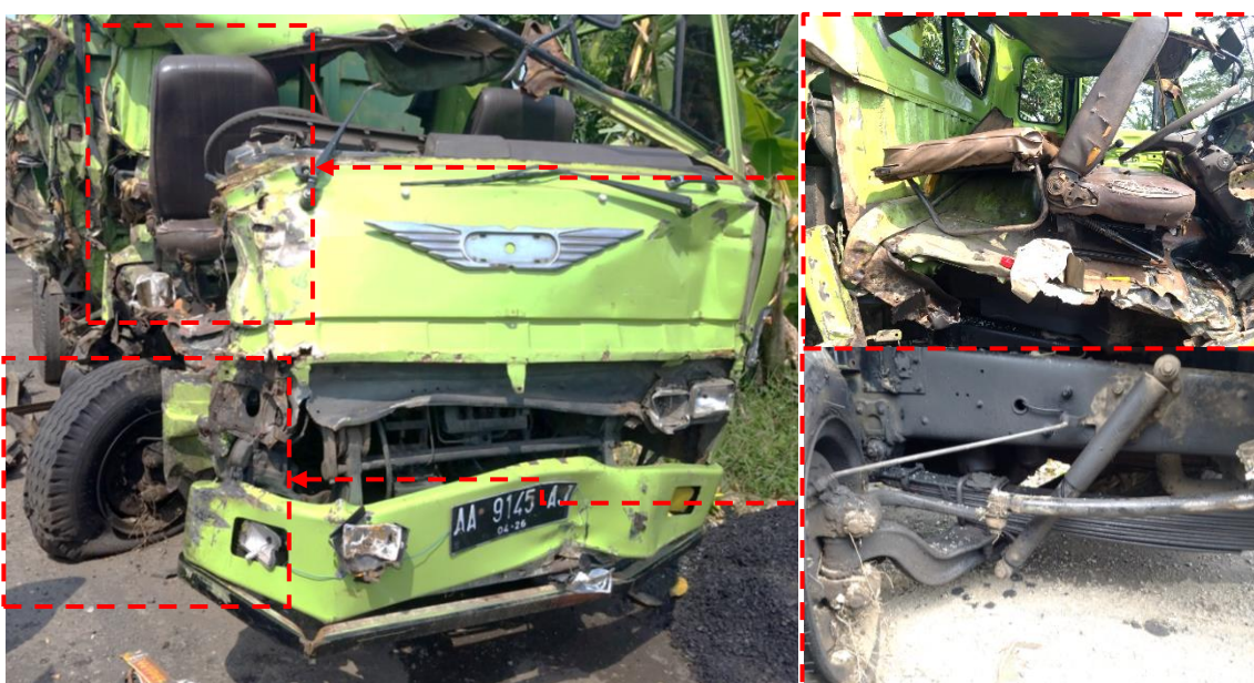
Gambar 2. Bodi kanan dumpruk rusak berat, tidak ada sabuk keselamatan di kursi pengemudi dan as roda tergeser
