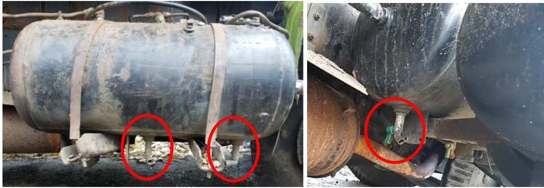
Gambar 4. Katup buang tangki udara bukan safety valve
