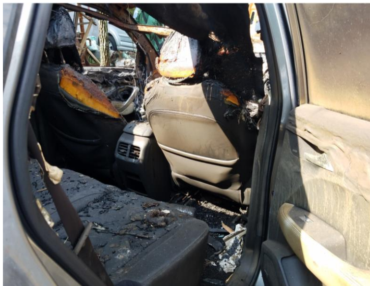
Gambar 5. Kabin belakang Wuling Almaz pasca terbakar
