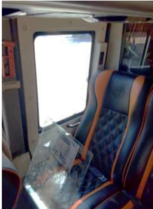
Gambar 8. Akses pintu darurat terdapat tempat duduk tidak mudah dilipat
