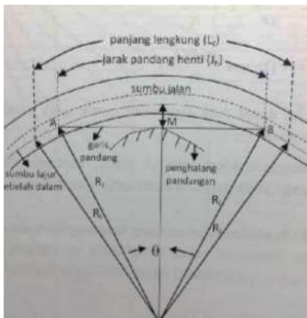
Gambar 23. Daerah bebas samping pada kondisi J_h < L_c [3]
