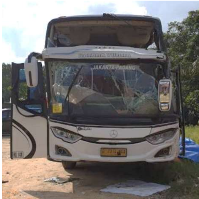
Gambar 4. Tampak depan bodi mobil bus deformasi ke kanan
