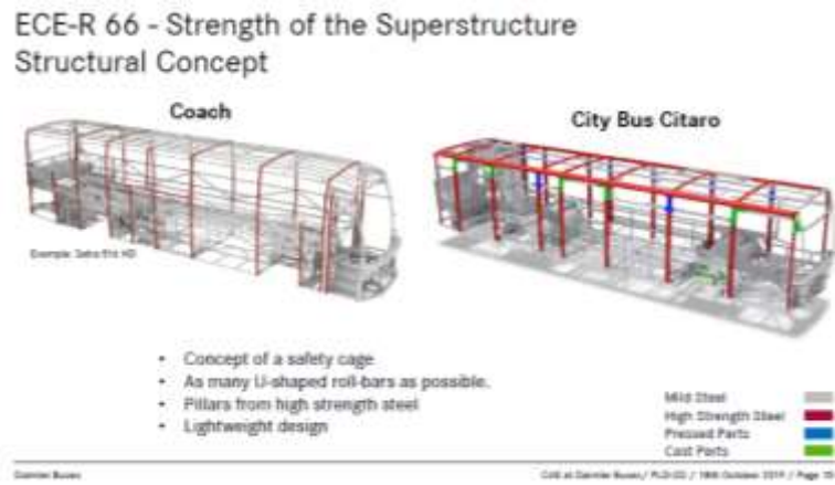
Gambar 24. Desain superstruktur mobil bus pilar bentuk U dari baja kekuatan tinggi (HSS)[4]
