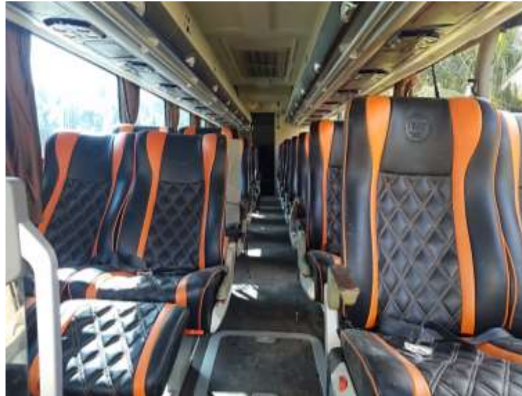
Gambar 6. Survival space tidak terdeformasi
