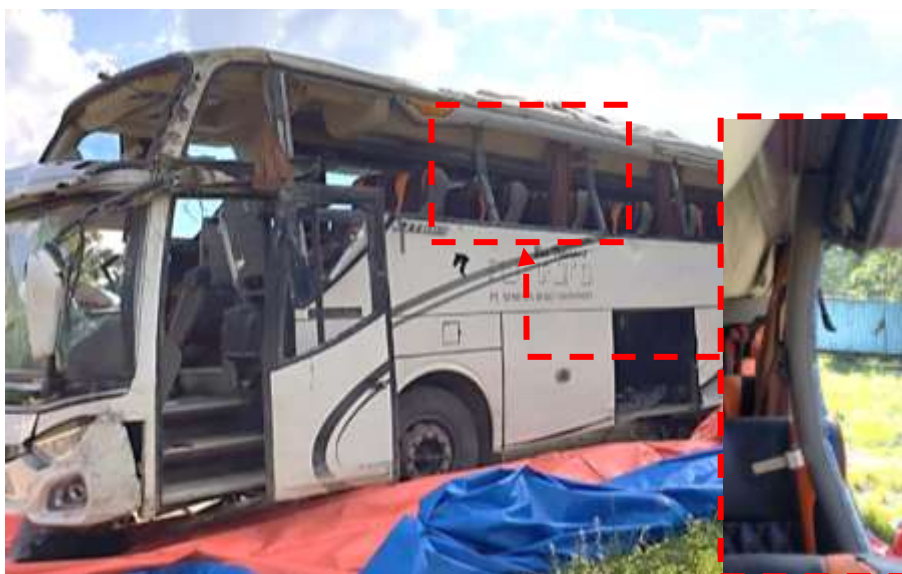
Gambar 3. Bodi kiri mobil bus deformasi superstruktur jendela
