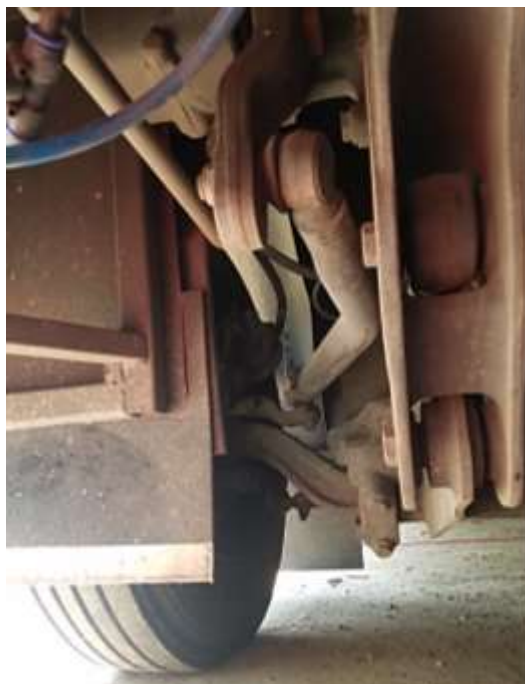
Gambar 10. Sistem kemudi mobil bus terhubung baik
