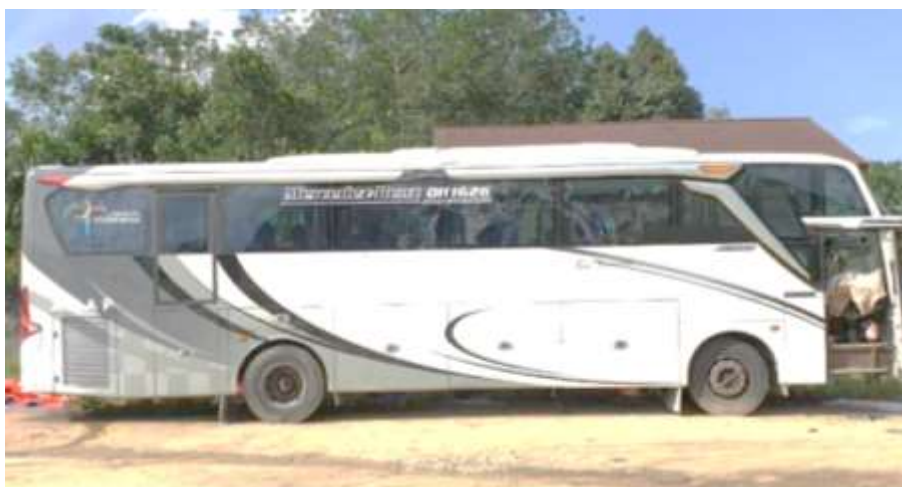
Gambar 2. Bodi kanan mobil bus tidak terdeformasi
