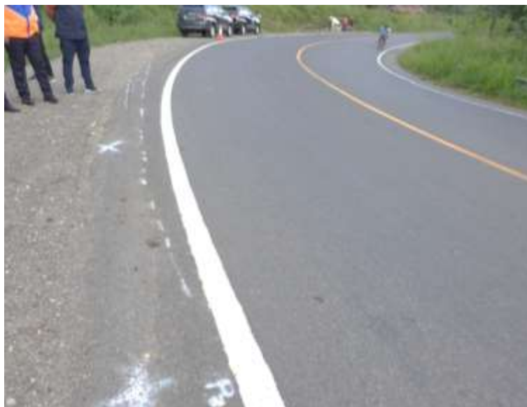
Gambar 19. Skid Marks ban mobil bus lurus menuju bahu jalan
