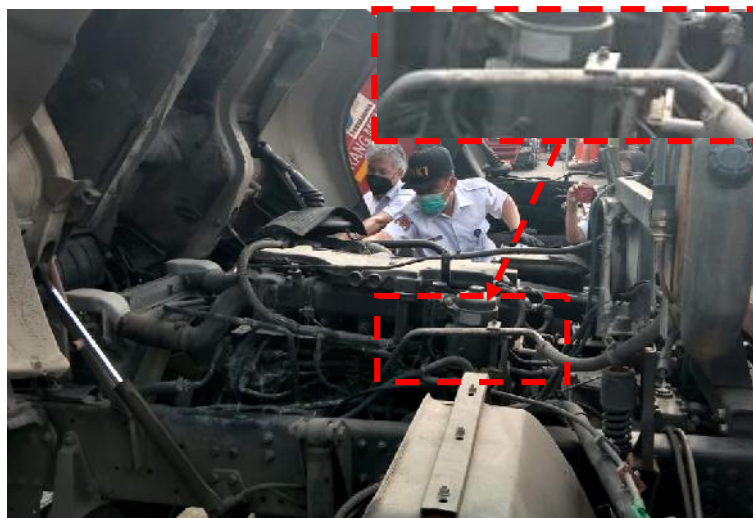
Gambar 11. Jejak gesekan antara cabin dengan selang logam
