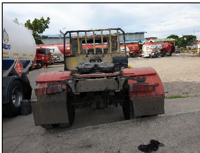
Gambar 4. Kondisi bagian belakang tractor head yang terbakar
