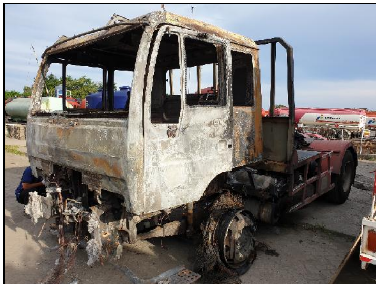
Gambar 3. Kondisi bagian sebelah kiri tractor head yang terbakar
