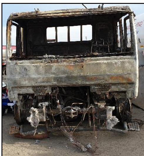
Gambar 2. Kondisi bagian depan tractor head yang terbakar
