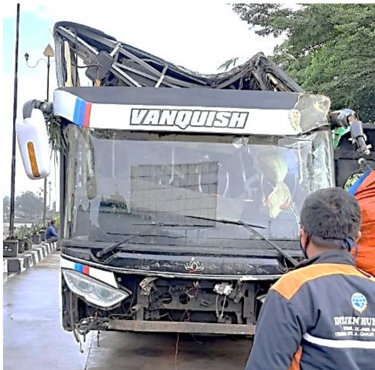
Gambar 5. Deformasi superstruktur bodi atas bus wisata
