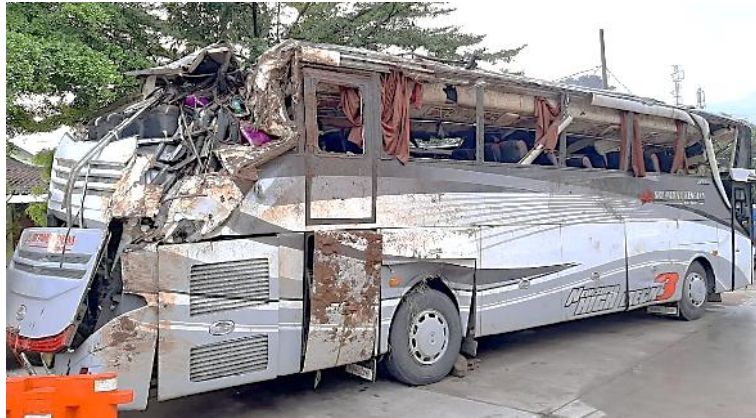
Gambar 4. Deformasi superstruktur bodi belakang bus wisata
