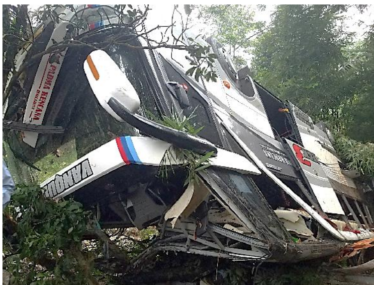
Gambar 2. Deformasi superstruktur atap bus wisata
