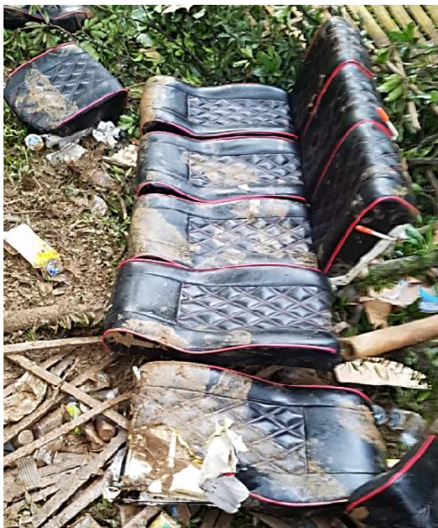
Gambar 12. Sabuk keselamatan tidak terpasang di semua kursi penumpang
