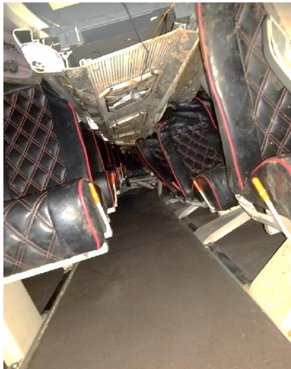
Gambar 8. Plafon bus wisata runtuh
