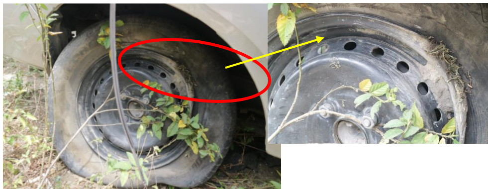
Gambar 7. Ban Belakang Kanan Tidak ada Tekanan Udara
