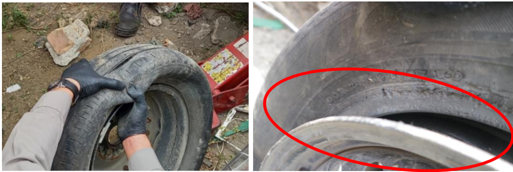
Gambar 8. Ban Belakang Kiri Sobek pada Alur Telapak Ban dan Velg Tergores
