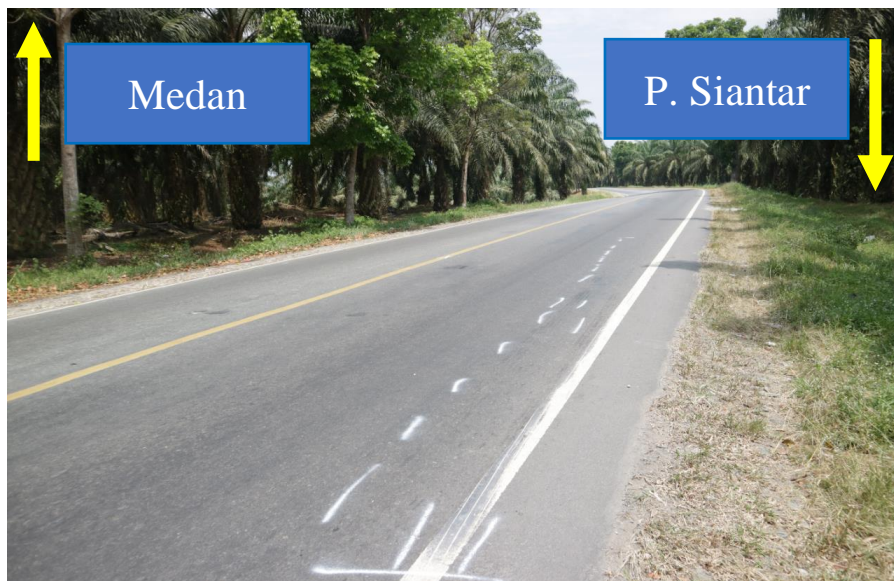
Gambar 16. Jejak Pengereman Mobil Bus Sepanjang 10 meter
