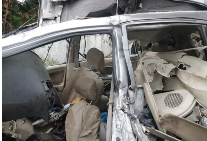
Gambar 4. Ruang Survivor Space Terdeformasi dari Arah kiri
