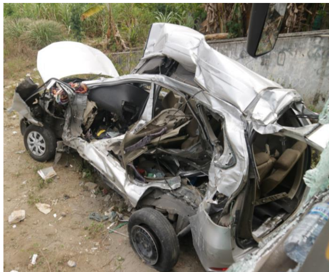
Gambar 3. Bodi Mobil penumpang Samping Kiri Rusak Berat
