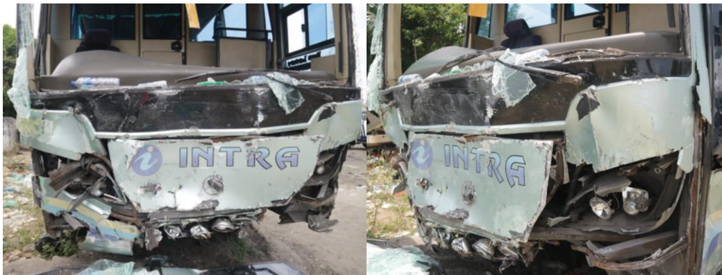
Gambar 9. Bodi Mobil Bus Bagian Depan Terdeformasi
