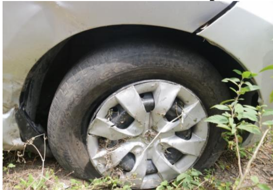
Gambar 6. Kondisi Ban Depan Kanan Sobek dan Lepas dari Velg
