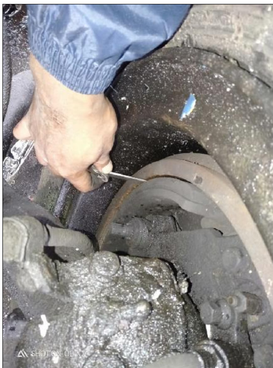
Gambar 12. Celah antara kanvas rem dengan tromol sebesar 2.6 mm
