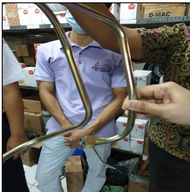
Gambar 8. selang udara truk terbuat dari bahan tembaga
