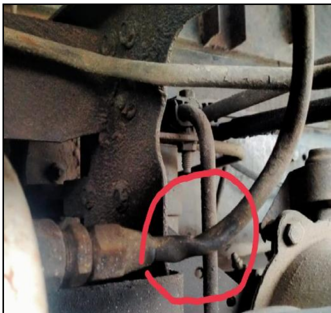
Gambar 7. Kondisi selang rem terpuntir
