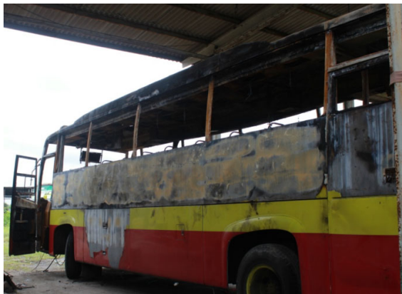
Gambar 3. Tampak samping kiri mobil bus pasca kebakaran
