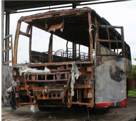
Gambar 2. Tampak depan mobil bus pasca kebakaran
