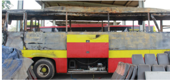
Gambar 5. Tampak samping kanan dan ruang battery mobil bus pasca terbakar
