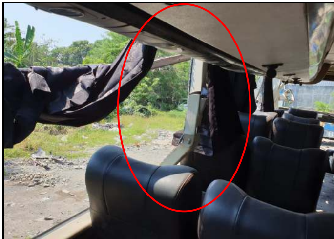
Gambar 11. Superstruktur jendela deformasi ke dalam kabin
