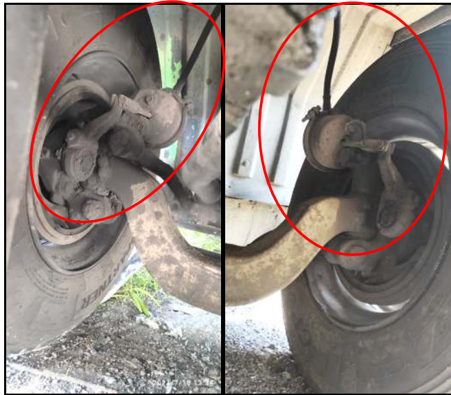
Gambar 10. Flexible hose terpasang ke brake chamber dan tidak getas
