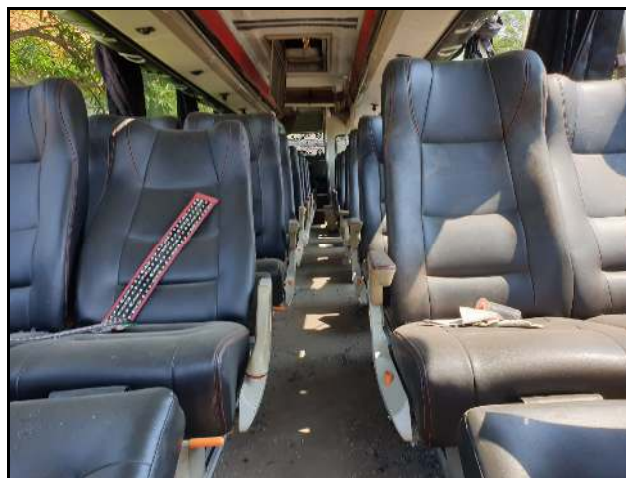
Gambar 6. Kursi penumpang tidak dilengkapi dengan sabuk keselamatan (safety belt)
