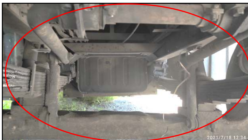
Gambar 9. Stabilizer bar terhubung dan tidak aus
