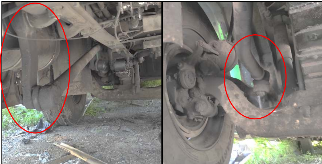
Gambar 8. Sambungan kemudi pitman, draglink dan knukle ke roda terhubung dan tidak ada aus
