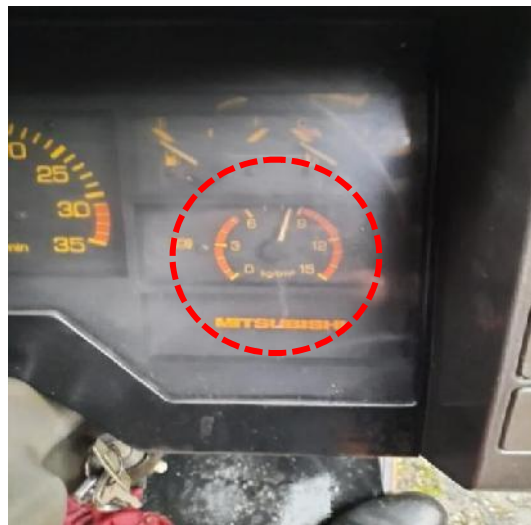
Gambar 8. Proses pengisian udara bertekanan 8 bar selama 2,4 menit
