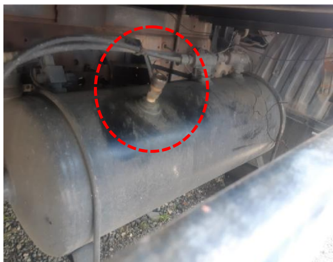
Gambar 6. Sambungan pipa klakson truk tronton dari safety valve air tank
