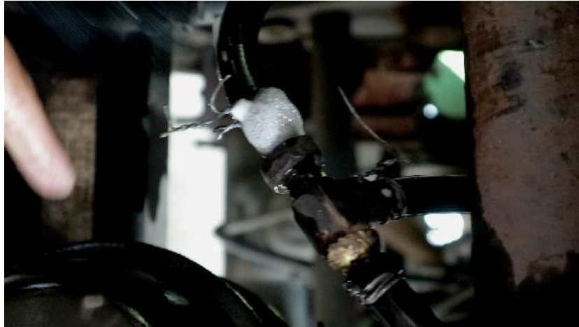
Gambar 15. Kebocoran pada sistem selang pengereman
