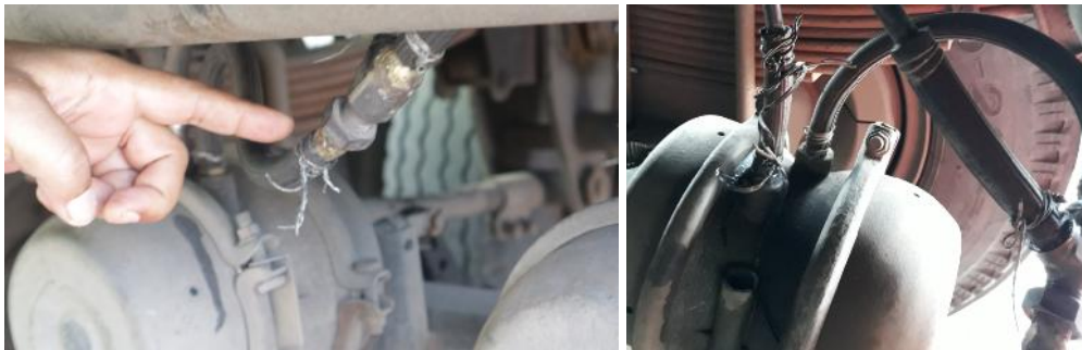
Gambar 14. Kawat yang digunakan untuk mengikat selang rem
