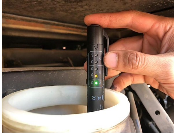
Gambar 14. Hasil diagnostik brake fluid tester minyak rem kadar air kurang dari 1%
