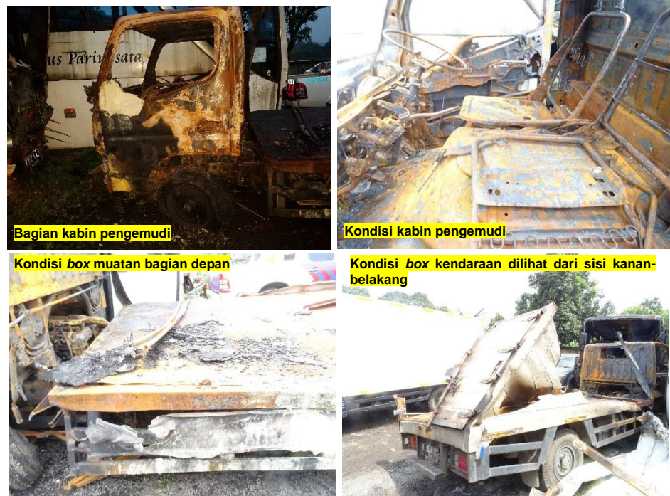
Gambar 4. Kondisi mobil box pasca evakuasi.
