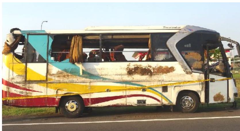
Gambar 3. Goresan di bodi kanan mobil bus akibat terguling
