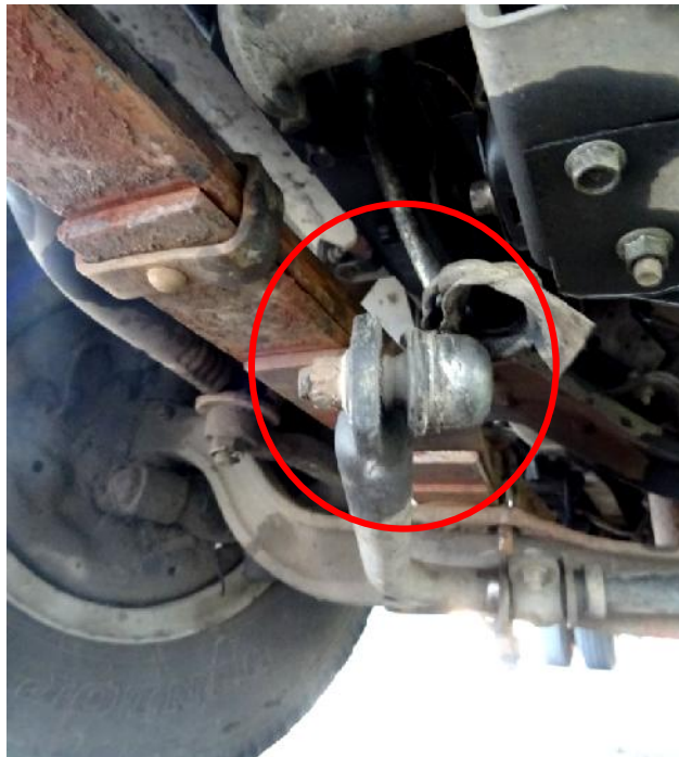
Gambar 10. Bushing sobek pada stabilizer bar
