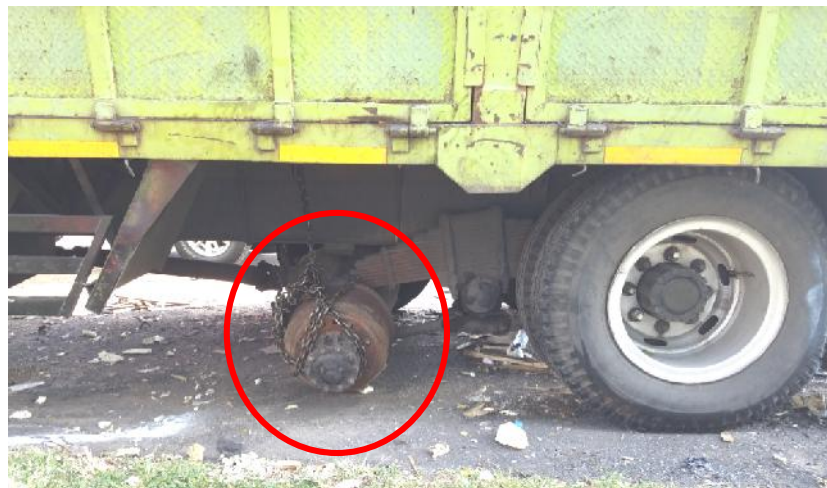
Gambar 12. Baut roda patah di sumbu kedua
