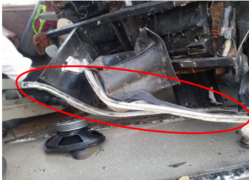
Gambar 4. Rel kursi mobil bus terlepas dari lantai
