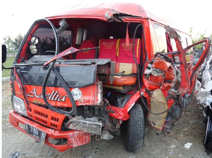
Gambar 14. Deformasi bodi depan kiri
