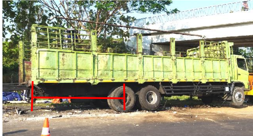
Gambar 11. Panjang ROH truk tronton 4200 mm
