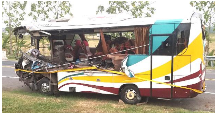
Gambar 2. Bodi depan kiri mobil bus terbelah diatas lantai sepanjang ± 5 meter
