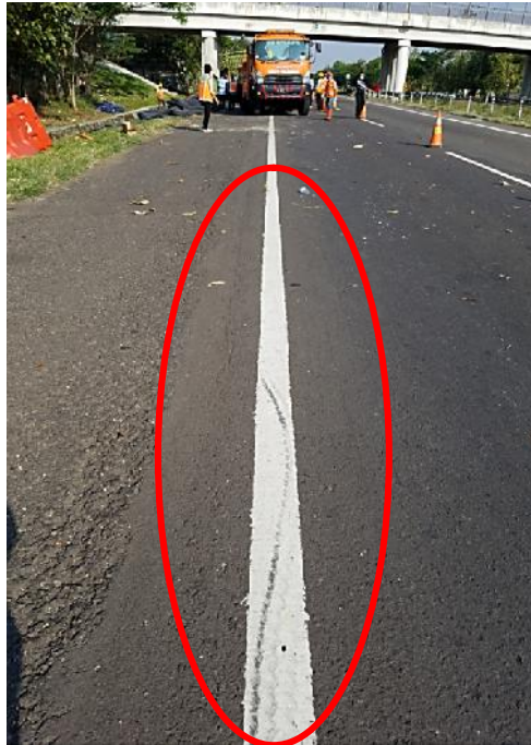
Gambar 18. Jejak telapak ban mobil bus \pm 20 meter sebelum titik tabrakan
