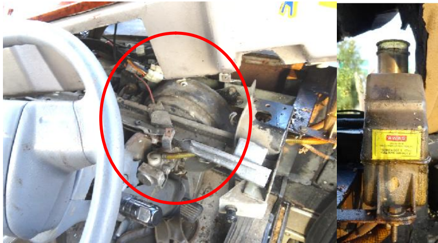
Gambar 7. Rem Utama Sistem Hidraulis dengan Vacuum Servo Assistance
