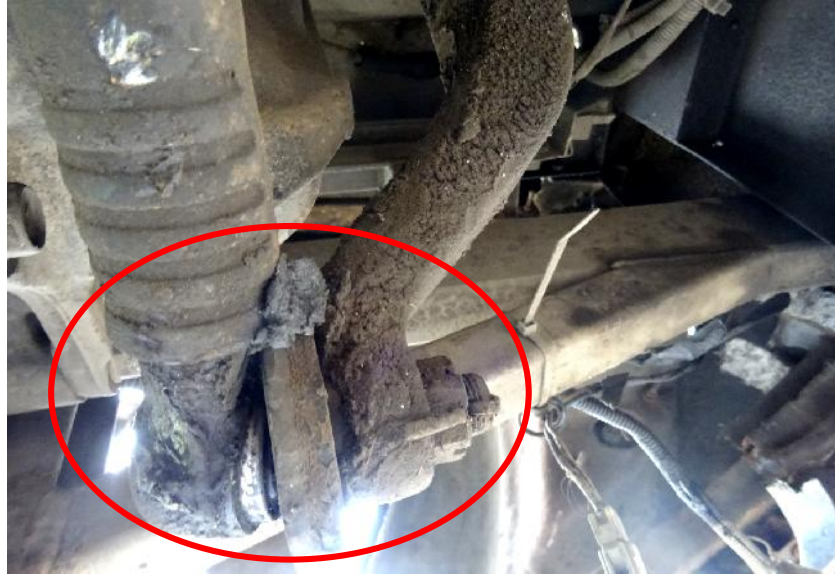
Gambar 9. Kondisi aus joint draglink steering ball nut type
