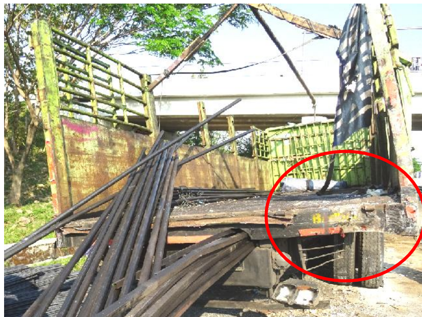
Gambar 13. 30% lebar bak kanan truk tronton yang tertabrak
