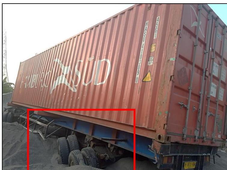
Gambar 4. Dua sumbu roda trailer terlepas
