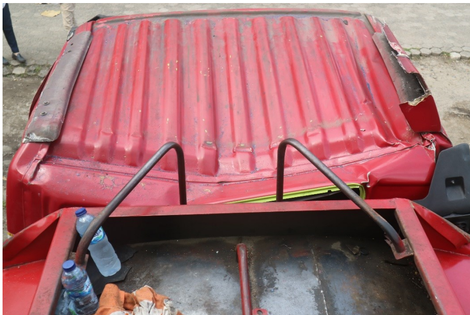
Gambar 3. Bagian atap kabin pengemudi yang terdeformasi.
