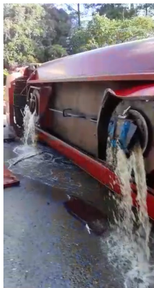
Gambar 8. Isi tangki yang keluar dari tutup main hole yang telah pecah.
