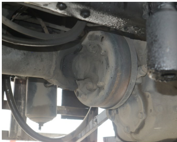
Gambar 18. Kondisi rumah rumah rem parkir di mobil tangki lainnya yang dalam keadaan bersih.
