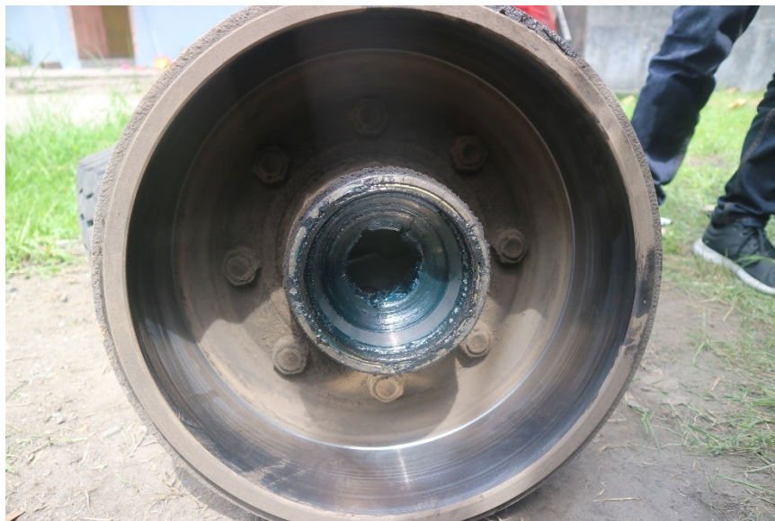
Gambar 16. Kondisi tromol roda kiri-depan mobil tangki.
