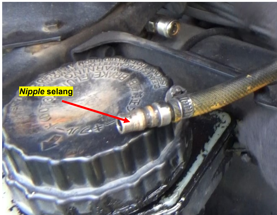
Gambar 14. Nipple selang yang kondisinya longgar.
