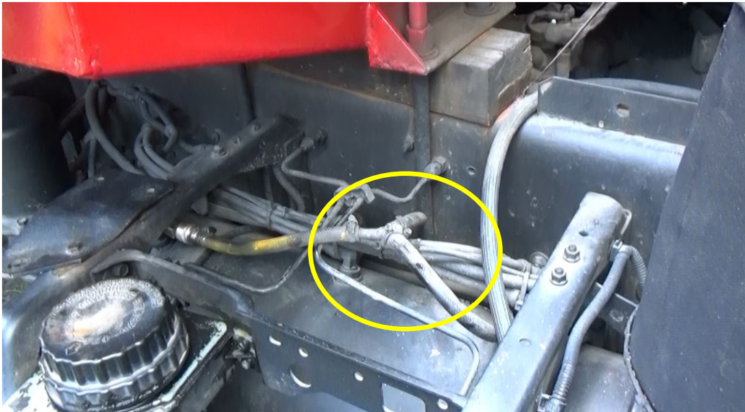
Gambar 28. Percabangan pada selang flexible tangki udara mobil tangki.
