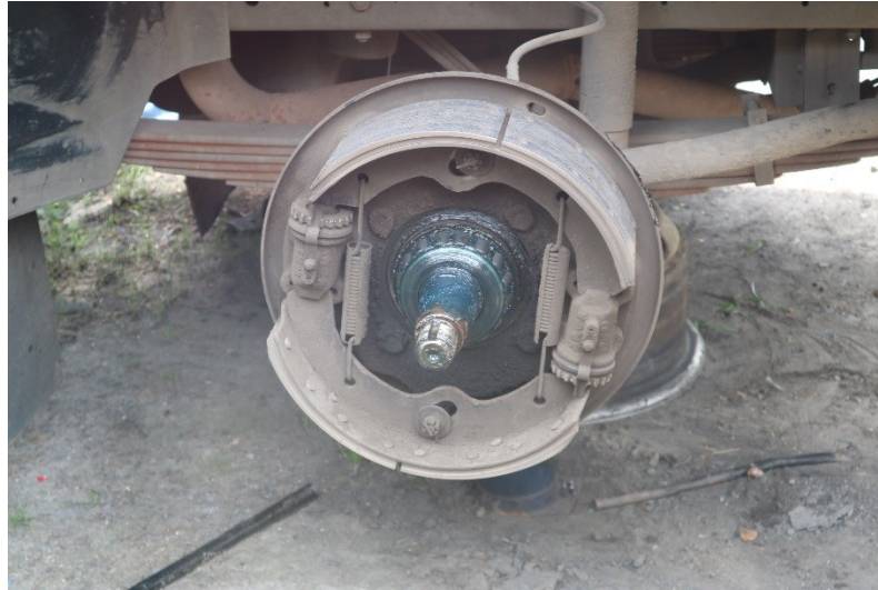
Gambar 15. Kondisi rem roda kiri-depan mobil tangki.
