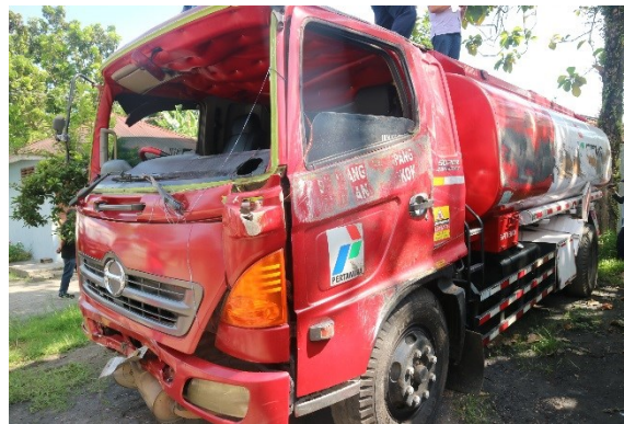
Gambar 5. Kondisi kaca depan mobil tangki yang telah pecah.
