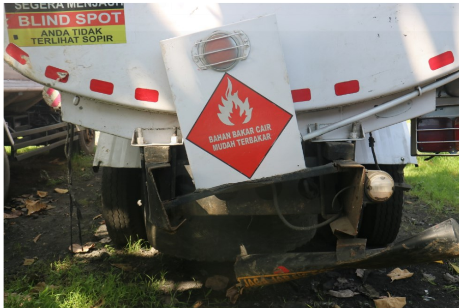
Gambar 2. Bumper belakang mobil tangki yang terlepas dan terdeformasi.
