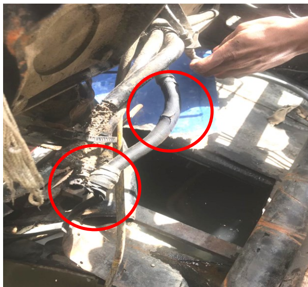
Gambar 3. Selang udara dalam keadaan terputus, retak dan diikat dengan karet ban
