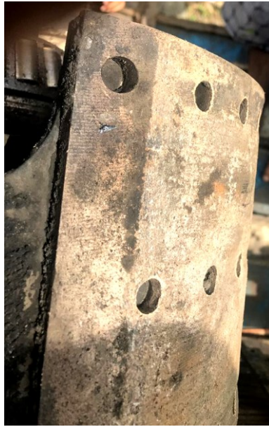
Gambar 5. Permukaan kampas pada ke-4 roda tidak rata
