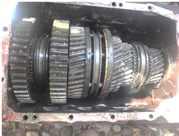
Gambar 9. Gigi persnelling pada posisi netral
