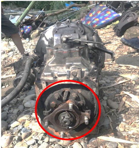
Gambar 7. Parking Brake shoe tidak terpasang (tidak ada rem tangan)
