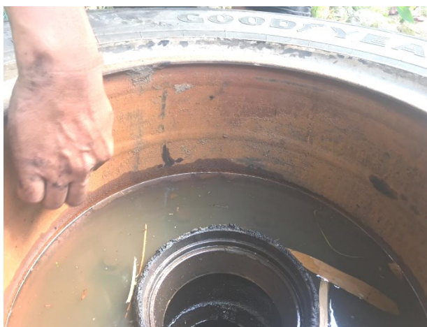
Gambar 4. Tromol mengalami perubahan bentuk ( ovality )
