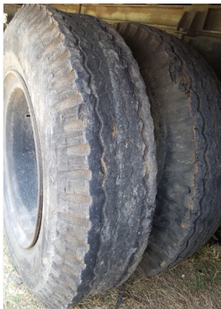
Gambar 10. Kondisi tebal telapak ban < 1mm
