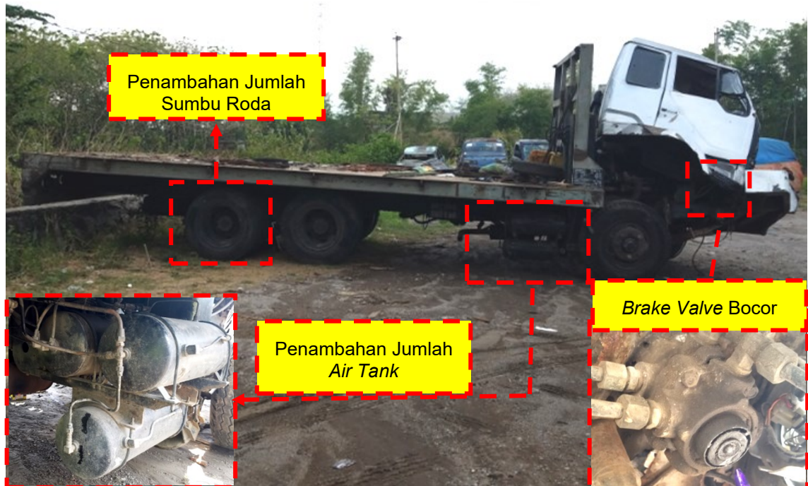
Gambar 5. Truk flat deck tampak samping kanan, penambahan jumlah sumbu roda dan jumlah air tank serta bocor pada brake valve
