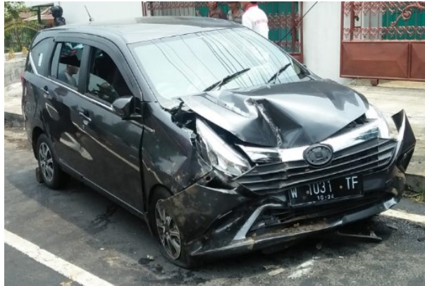
Gambar 13. Daihatsu Sigra deformasi pada bumper depan
