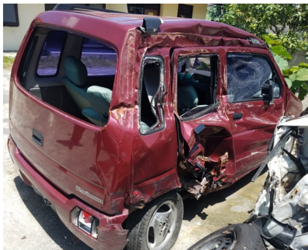
Gambar 14. Suzuki Karimun deformasi akibat tabrak samping
