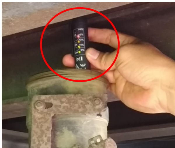
Gambar 7. Kadar air 4% dalam minyak rem
