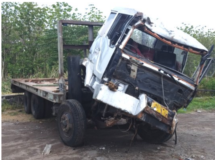
Gambar 4. Truk flat deck terdeformasi pada bagian depan
