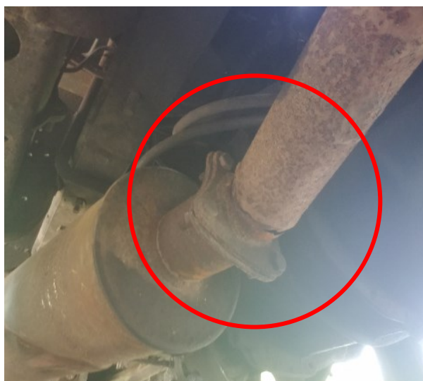
Gambar 8. Tidak ada Valve Exhaust Brake
