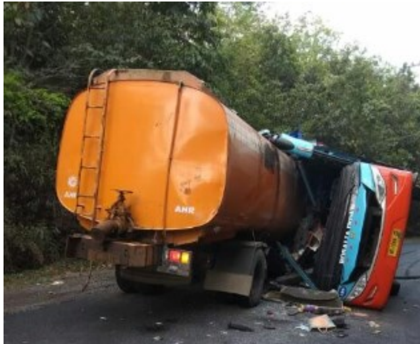
Gambar 5. Kerusakan bagian atap Mobil Bus AKAP tabrakan dengan muka truk tangki
