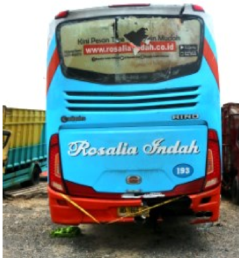
Gambar 4. Kerusakan bagian belakang Mobil Bus AKAP
