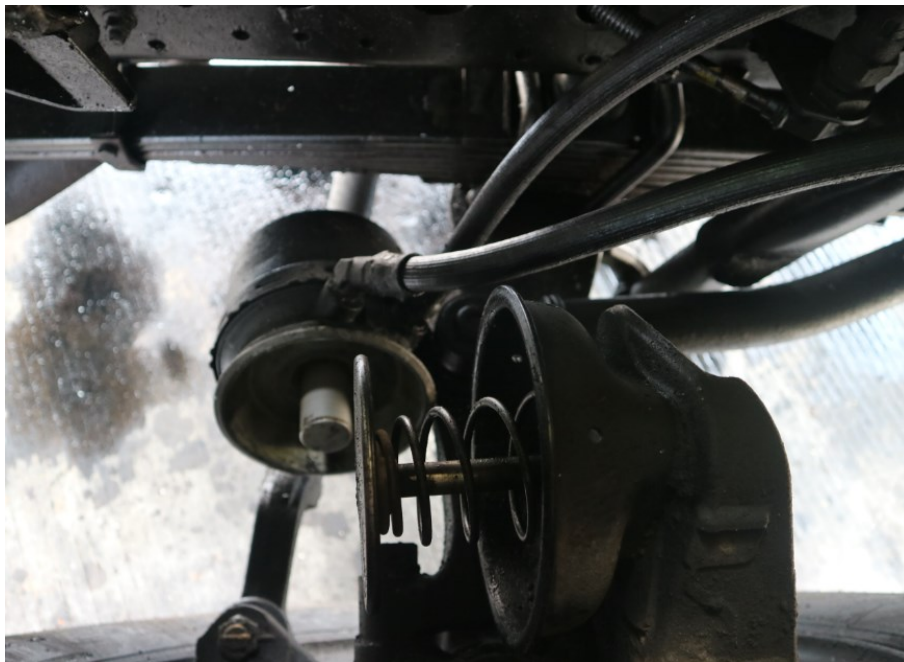
Gambar 7. Brake chamber dump truck terguling yang terbuka.
