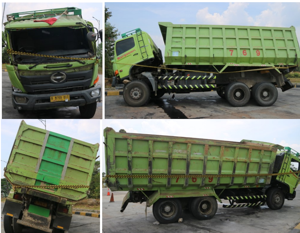
Gambar 5. Kondisi Dump truck B yang terguling.
