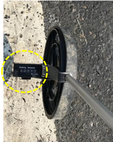
Gambar 14. Jarak 89 meter yang Diukur dari Truk Trailer Tangki Pertama Kali Melakukan Pengereman hingga Berhenti saat Menabrak Pagar Pengaman
