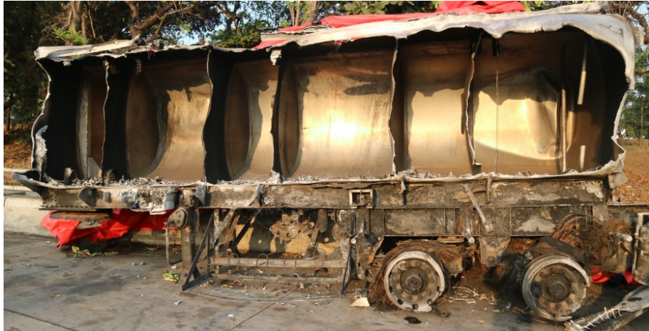
Gambar 18. Trailer Tangki Rusak Setelah Terjadinya Ledakan dan Kebakaran
