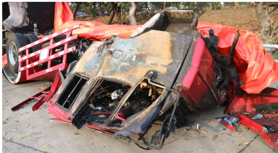
Gambar 17. Tractor Head Terdeformasi Setelah Jatuh dari Flyover dan Terbakar
