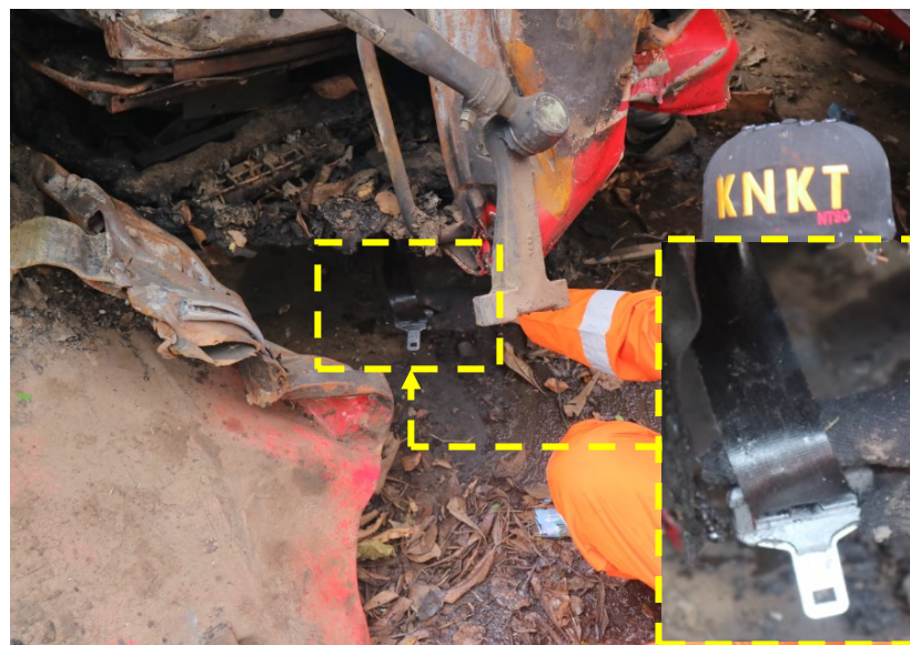
Gambar 21. Pengikat ( Fitting ) Sabuk Keselamatan Pengemudi (AMT1) Tidak Terpasang pada Pengunci Sabuk ( Buckle )
