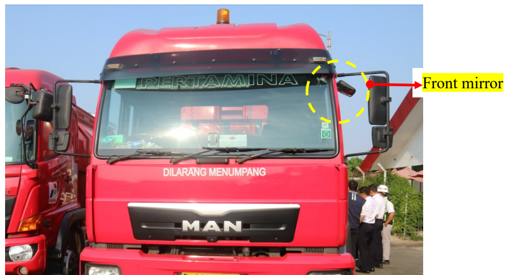
Gambar 28. Front Mirror yang Terpasang pada Truk Trailer Tangki
