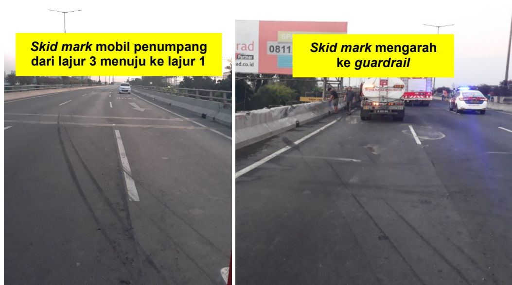
Gambar 11. Skid Mark Mobil Penumpang dari Lajur 3 Bergeser ke Sisi Kiri
