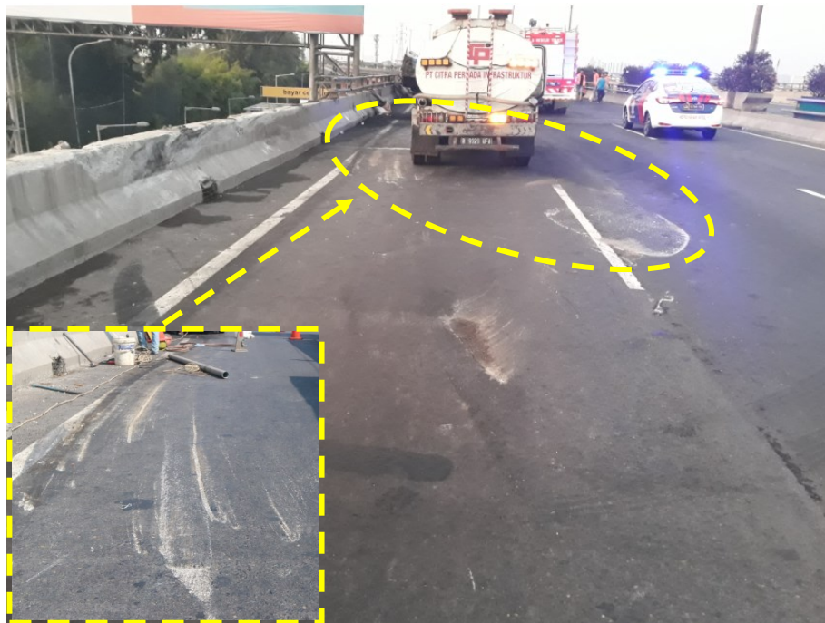
Gambar 13. Scratch Mark Truk Trailer Tangki di Permukaan Jalan
