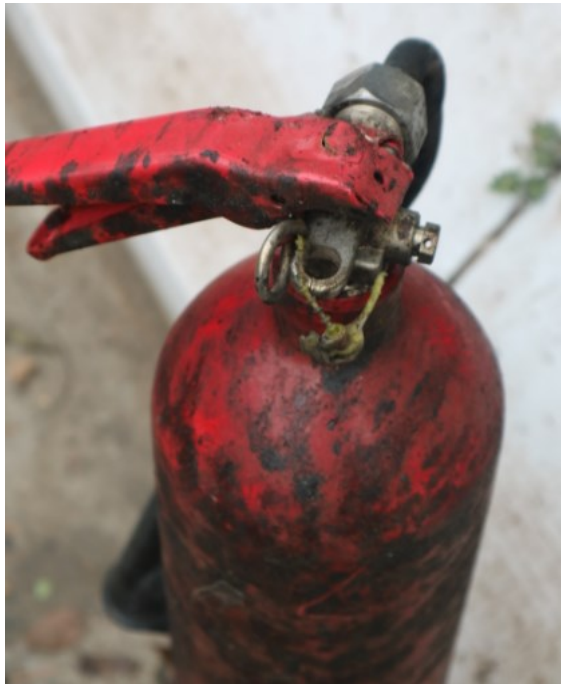
Gambar 19. Tabung APAR Truk Trailer Tangki Masih Terkunci
