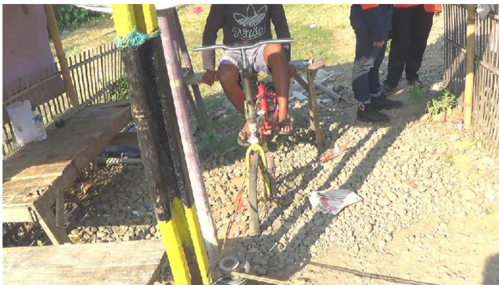
Gambar 29. Kinematika sepeda bekas dan sistem katrol penggerak palang pintu perlintasan.
