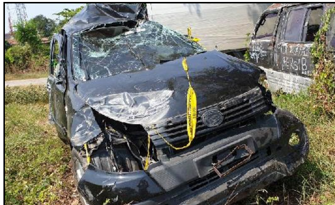
Gambar 4. Kondisi bagian depan mobil penumpang
