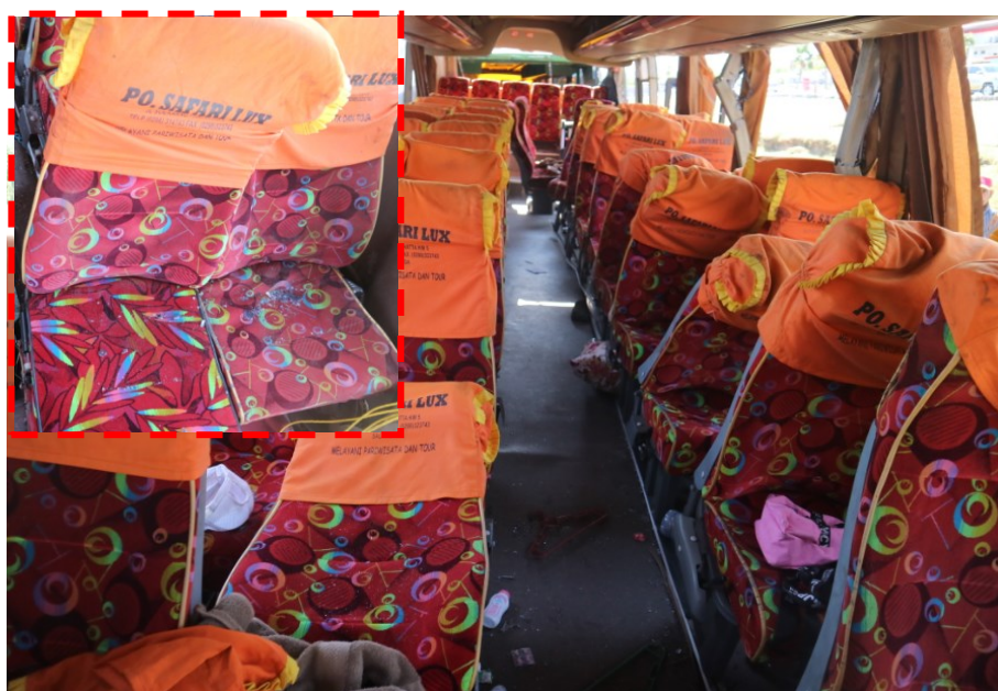
Gambar 5. Mobil Bus tidak tersedia sabuk keselamatan di semua kursi penumpang
