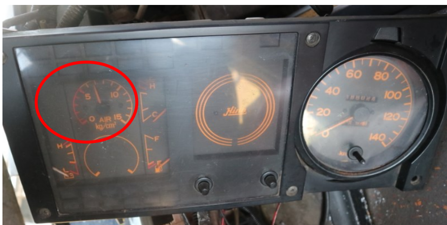
Gambar 3. Indikator udara bertekanan mobil bus diangka 7 bar
