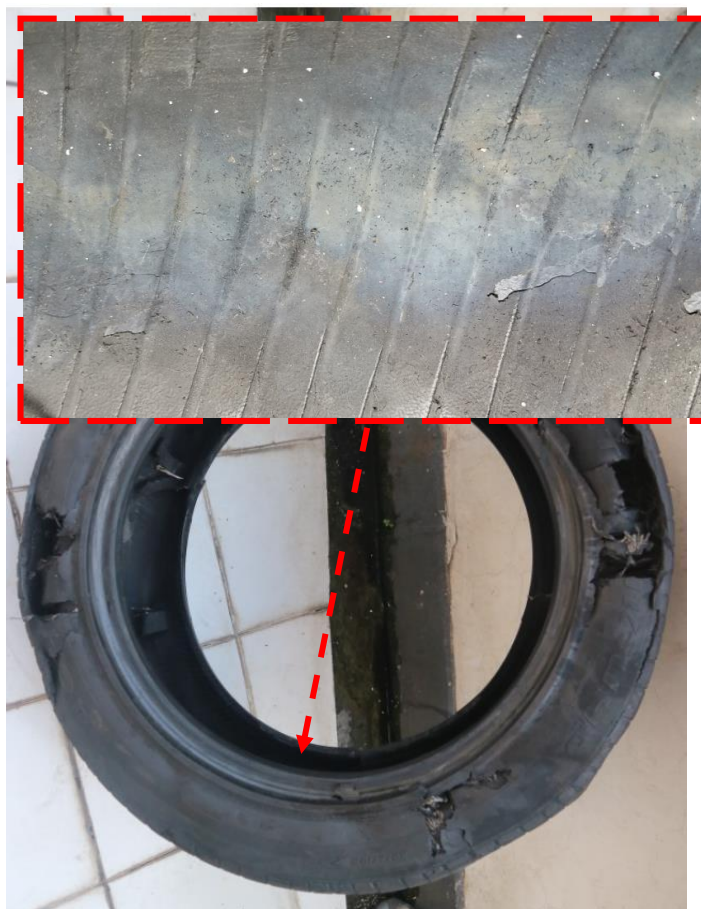
Gambar 12. Perubahan warna (ungu) bagian dalam ban belakang kiri
