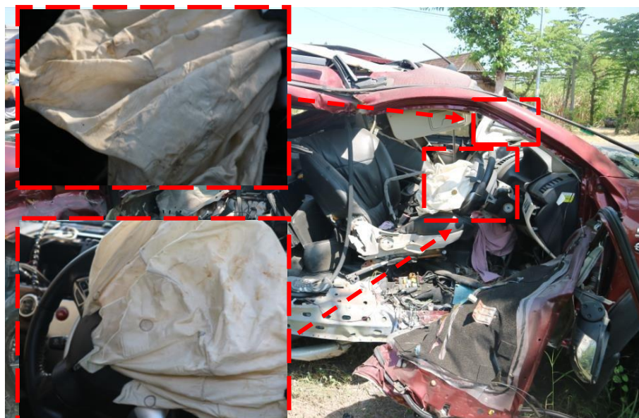
Gambar 14. Airbag depan pengemudi dan penumpang berfungsi
