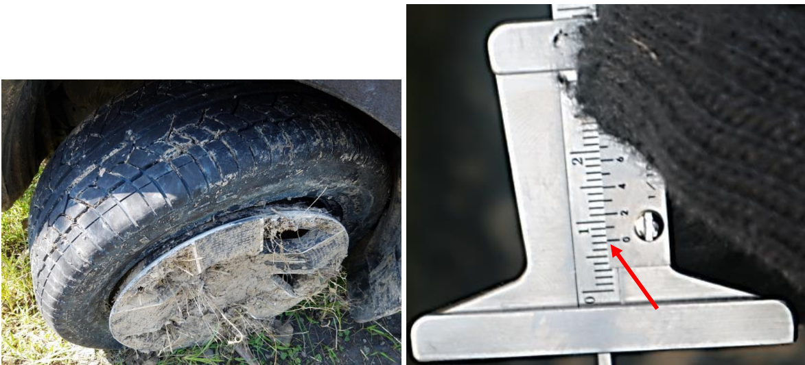
Gambar 8. Kondisi ban depan kiri tidak ada udara bertekanan, kedalaman alur ban 7,5 mm
