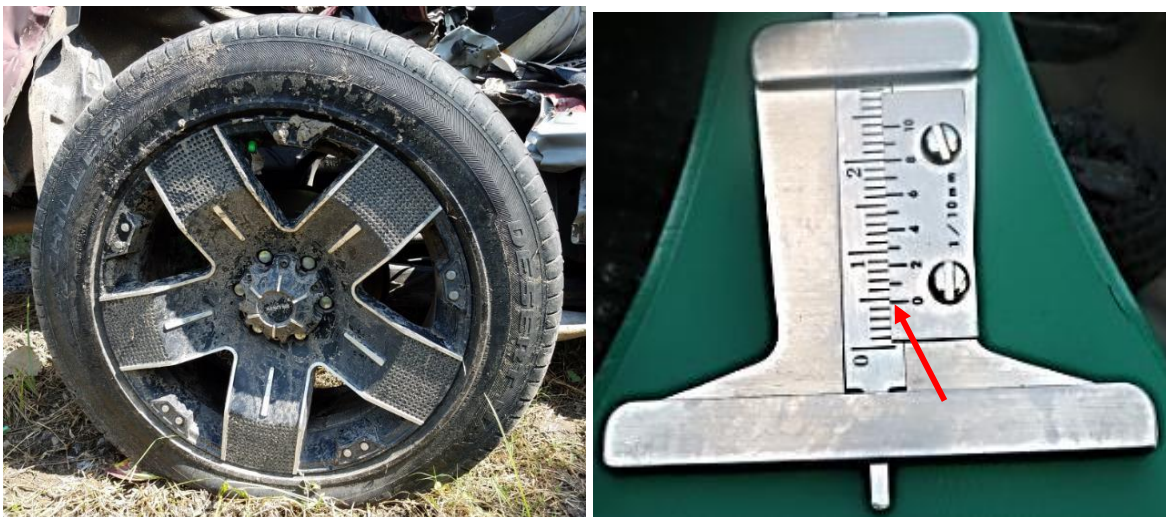
Gambar 10. Kondisi ban belakang kanan tidak ada udara bertekanan, kedalaman alur ban 4,5 mm
