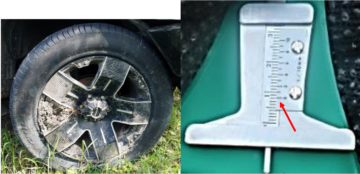
Gambar 9. Kondisi ban depan kanan tidak ada udara bertekanan, kedalaman alur ban 8 mm
