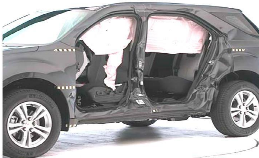
Gambar 24. Contoh Airbag samping di struktur yang terdeformasi
