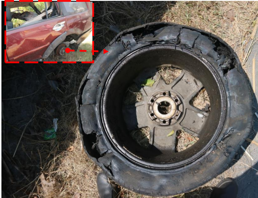
Gambar 11. Kondisi ban belakang kiri bagian dinding dalam robek melingkar
