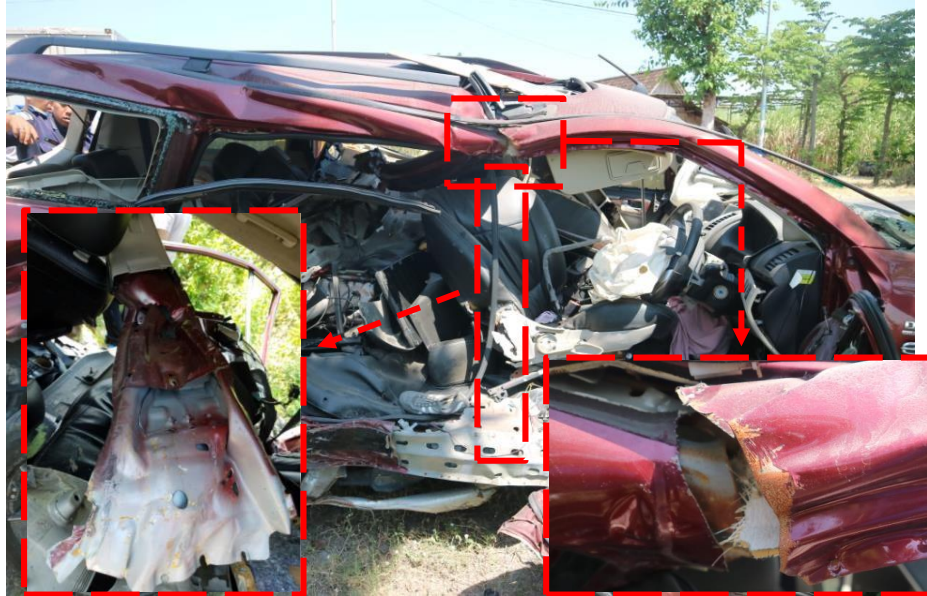
Gambar 15. Deformasi struktur sisi B-Pillar terlepas dari lantai
