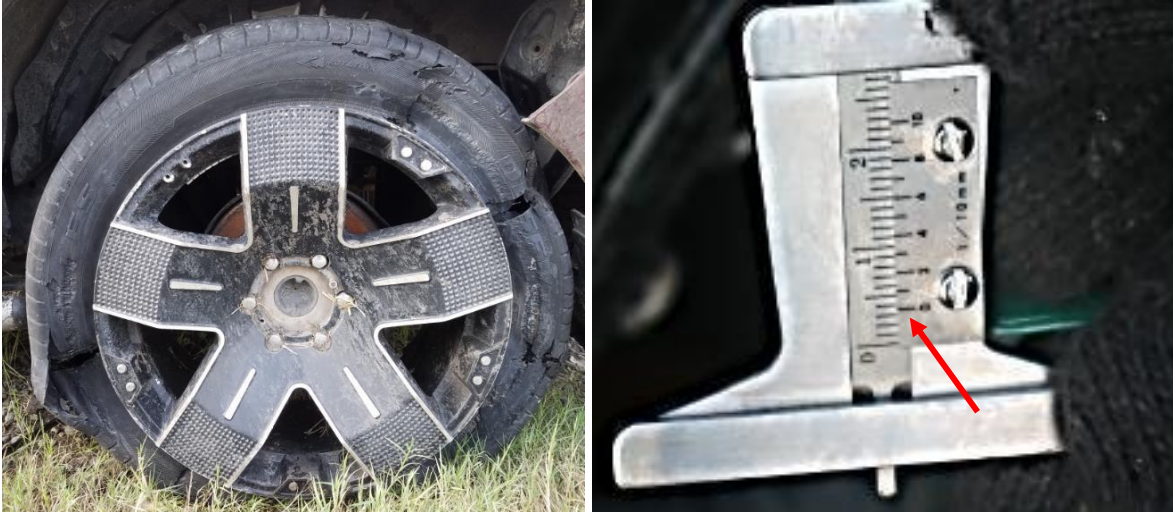
Gambar 7. Kondisi ban belakang kiri banyak sobek, kedalaman alur ban 3,5 mm
